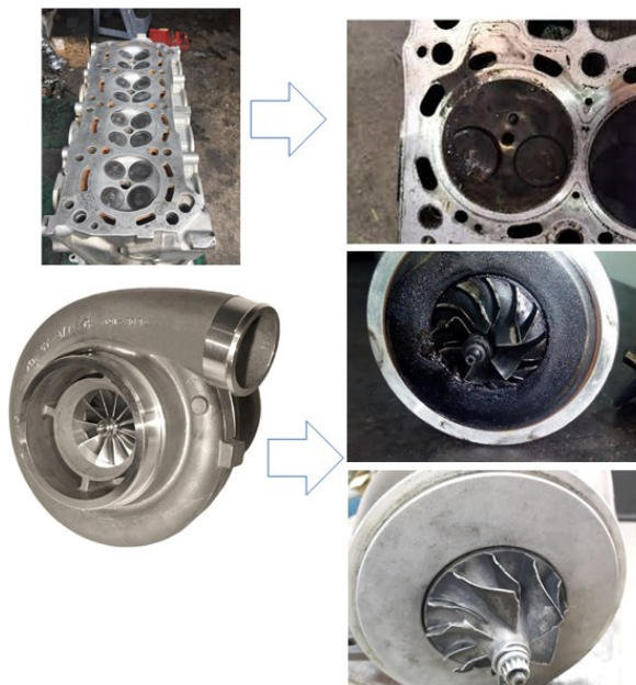
Figura 2. 34: Averías en el sistema GDI
