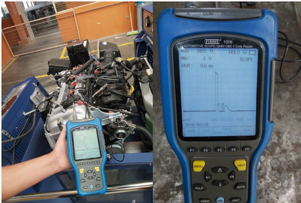
Figura 2. 44: Prueba del inyector mediante el osciloscopio.
