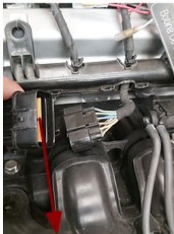
Figura 2. 38: Numeración del cableado de los inyectores.
