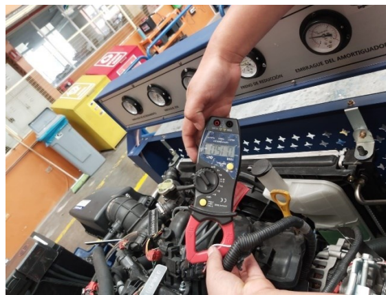
Figura 2. 45: Colocación de la pinza amperimétrica en el cableado del inyector.
