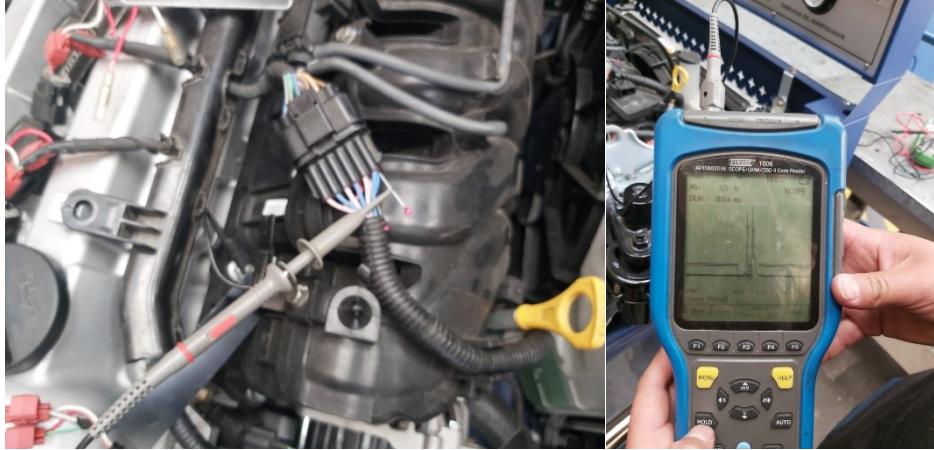
Figura 2. 43: Colocación de la sonda del osciloscopio en los cables del inyector.
