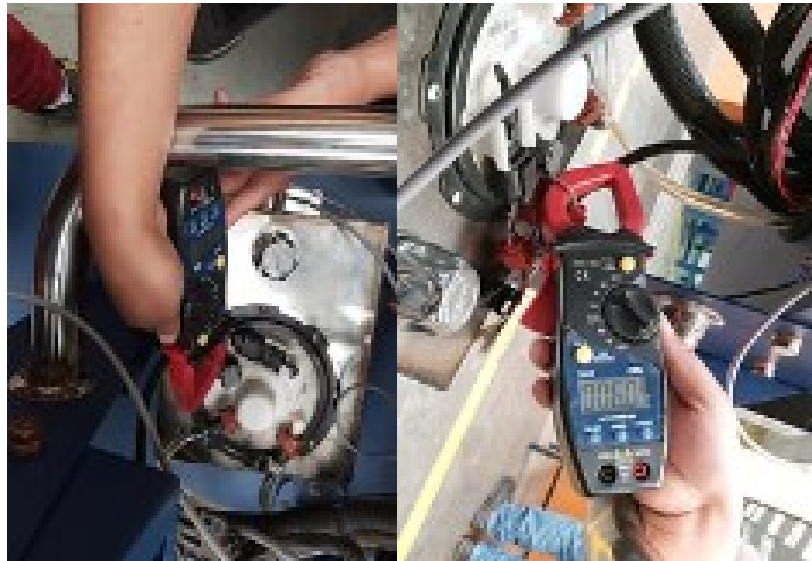
Figura 2. 42: Medición del amperaje.
