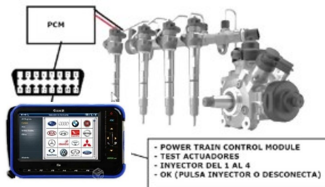
Figura 2. 40: Test de actuadores.
