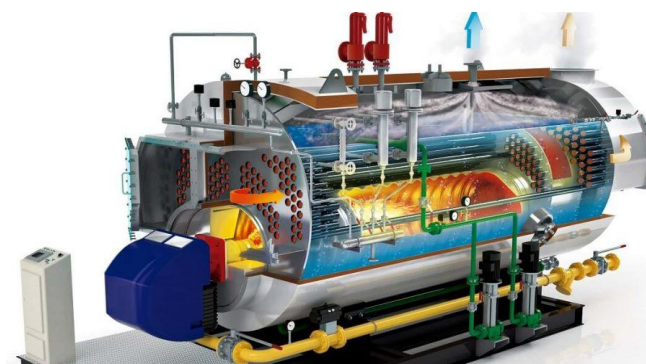
Figura 4. Interior de una caldera pirotubular.[19]
