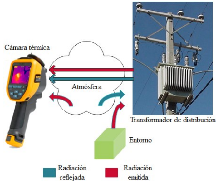
Figura 2.5. Radiación térmica de un objeto
