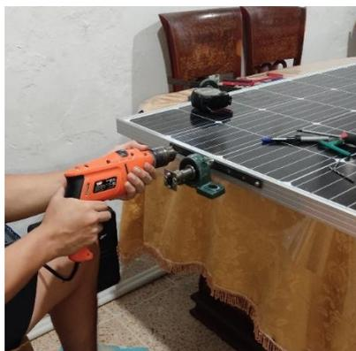
**Figura 3.3** Chumacera con rodamiento para soporte de panel solar 200W
