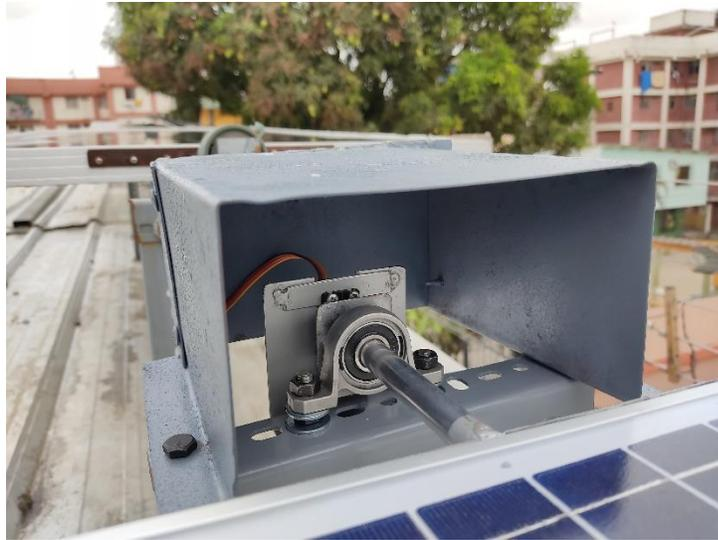
**Figura 3.14** Protección metálica para lluvia y sol en Servomotor
