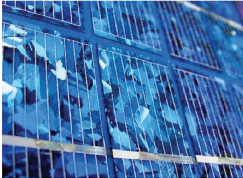
**Figura 2.11** Zoom de un panel solar policristalino de silicio (Bulnes & Brown, 2010)
