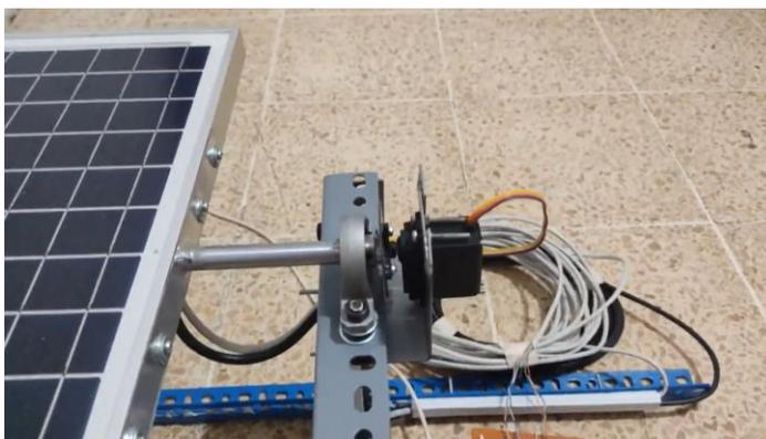
**Figura 3.8** Instalación de Servomotor en panel de 30W
