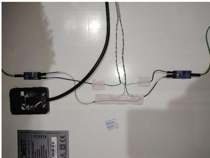
**Figura 3.12** Circuito convertidor de sensores de luz FT-1 y FT-2 en panel de 30W
