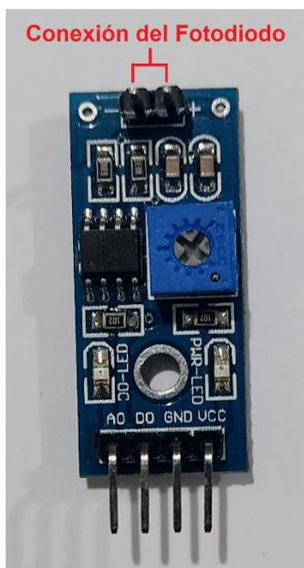
**Figura 3.28** Modulo sensor de luz
