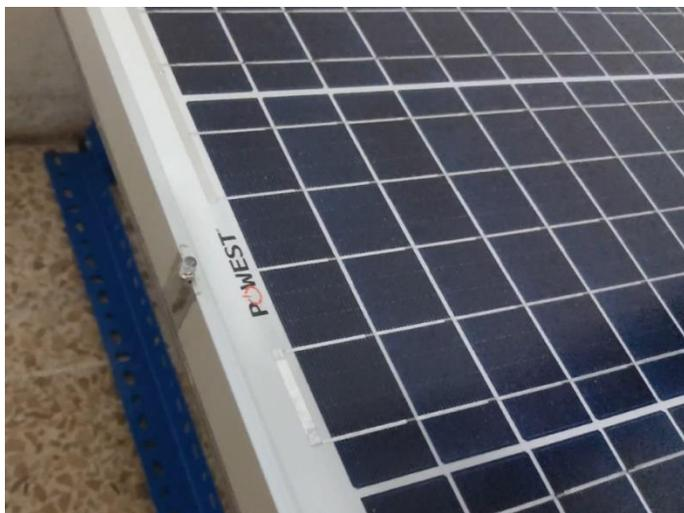
**Figura 3.10** Sensor de Luz FT-1 en panel solar de 30W
