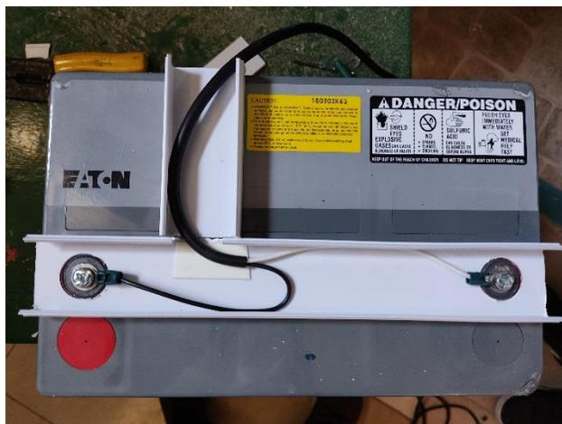
**Figura 3.23** Conexión de Batería 70Ah
