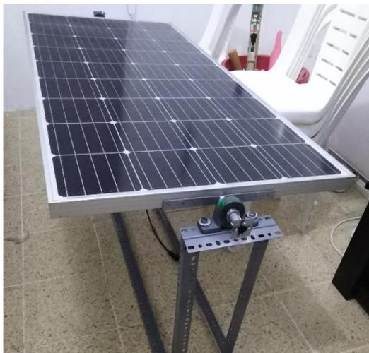
**Figura 3.4** Panel de 200W con soporte regulable
