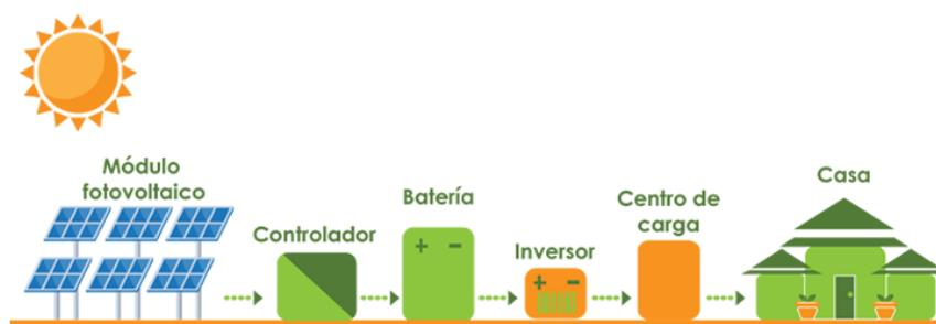
**Figura 2.17** Estructura del sistema fotovoltaico aislado (Imago, 2021)
