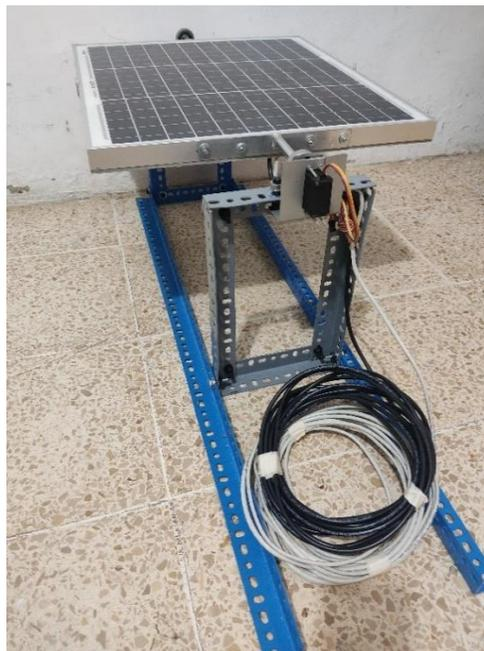
**Figura 3.9** Panel solar de 30W con soportes para montaje
