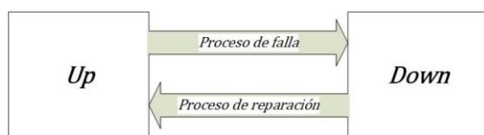
Figura 10. Modelo de dos estados de un componente.
