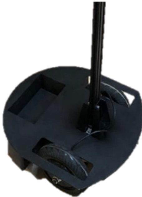
Figura 23: Base inferior y tronco del robot
