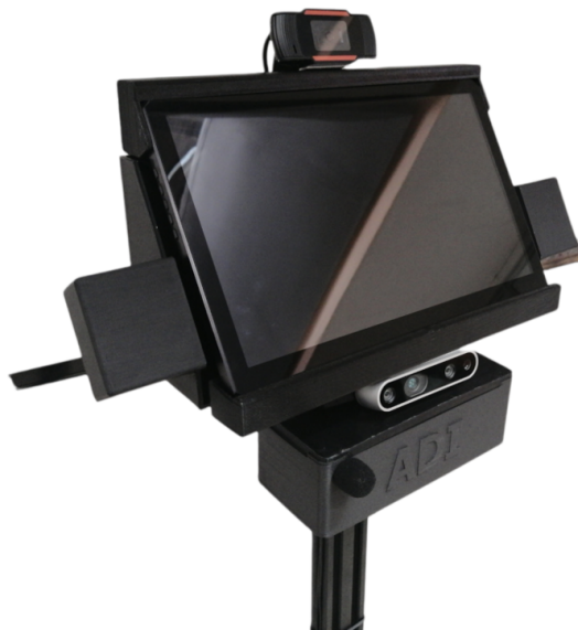
Figura 25: Soportes acoplados a la pantalla y perfil del robot
