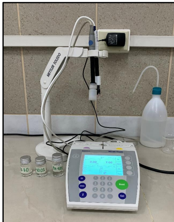
Figura 31. Medición del pH en muestras de suelo.
