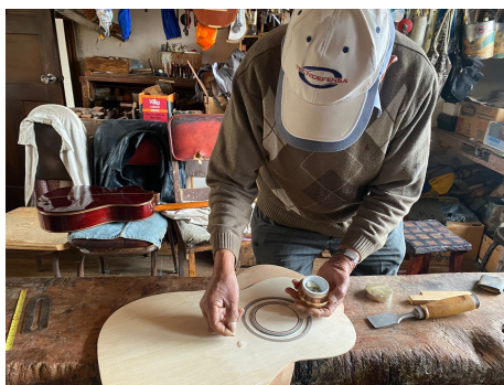
Figura 1. Incrustaciones de la roseta. Ejemplificar el complejo proceso de fabricación de una guitarra artesanal Fuente: Autora
