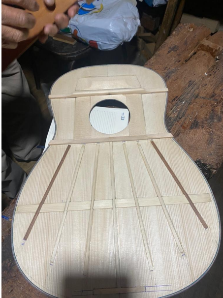
Figura 4. Varetaje en abanico. Demostrar la ingeniería interna de la guitarra Fuente: Autora
