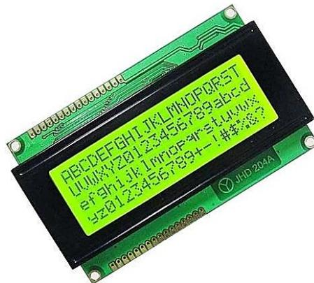
Fig. 27.- LCD 20x4
