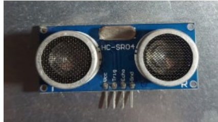
Figura 28: Sensor ultrasónico HC-SR04.
