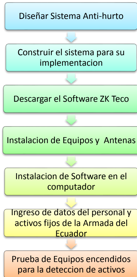
Figura 12 Proceso para la instalación del sistema antihurto
