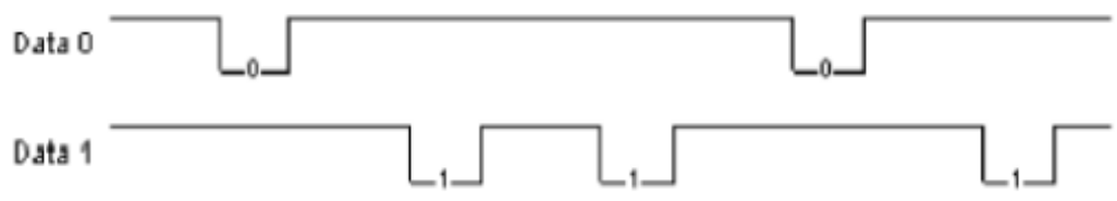
Figura 1 Adaptación del Protocolo Wiegand
