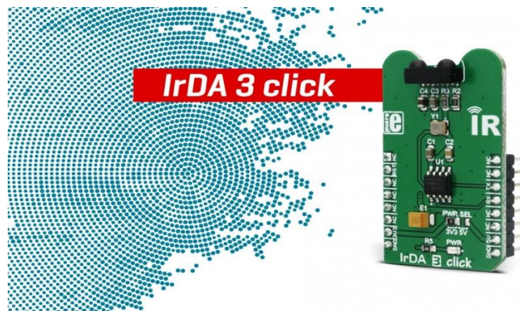
Figura 3. IrDA 3 click, dispositivo transceptor de infrarrojos. [32]
