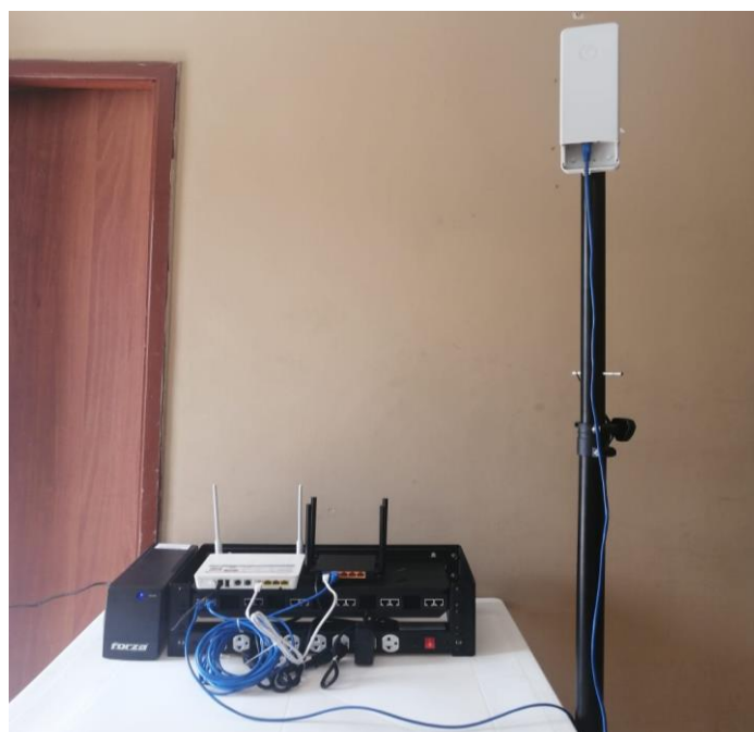
Figura 43. Resultado final de la conexión entre el router interno del WISP y la antena principal, se realizó de manera satisfactoria.
