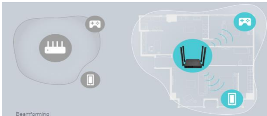
Figura 34. Funcionamiento de la tecnología beamforming. [48]
