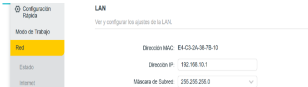
Figura 41. Configuración de red del router AP interno
