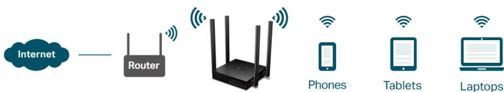
Figura 37. Diagrama del router en modo extensor de rango. [49]
