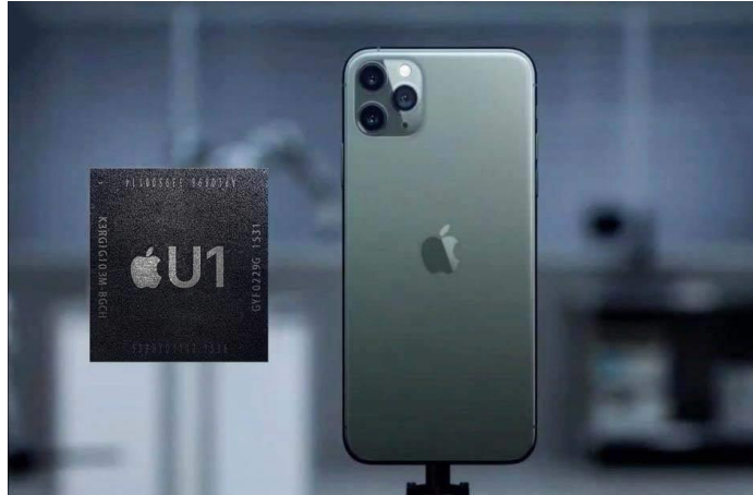
Figura 5. Chip U1 de Apple desarrollado con tecnología UWB. [34]
