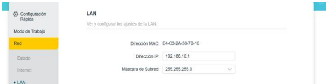
Figura 35. Dirección IP del router modificada
