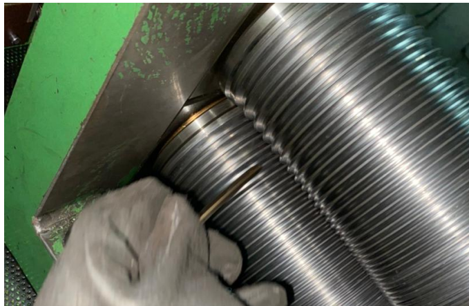
Figura 4: Proceso de laminado JCRM.
