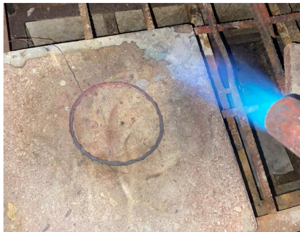
Figura 6: Proceso de recocido JCRM.
