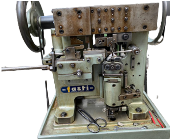
Figura 29: Máquina FASTI para modelo de cadena Áncora espesor de hilo 0.25-1 mm.
