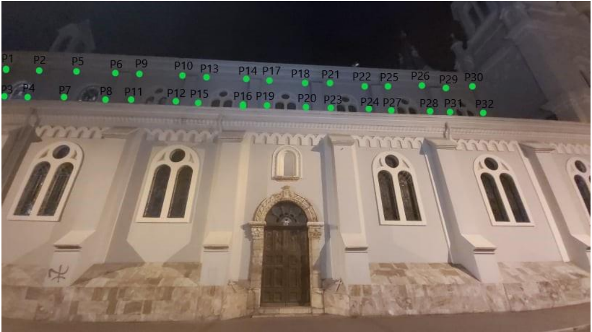
Fig. 50. Puntos de medición en la fachada lateral superior de la iglesia San Alfonso. [Autores]
