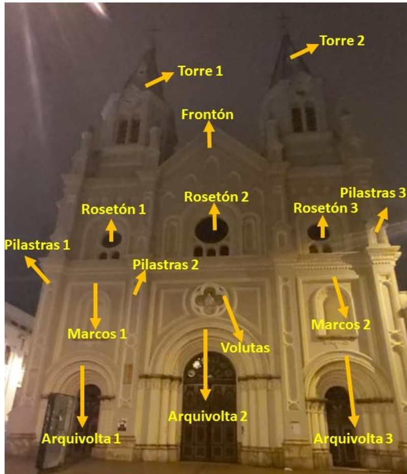
Fig. 52. Secciones de la fachada frontal iglesia San Alfonso. [Autores]
