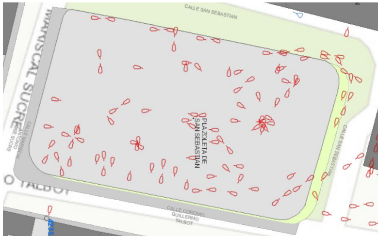
Fig. 7. Ubicación de las luminarias en el parque San Sebastián. [18]
