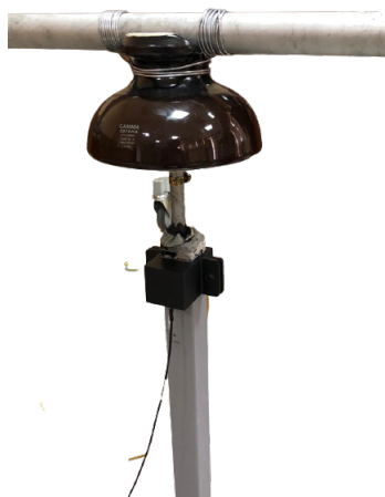
Figura 19: Sensor Acoplado a Aislador
