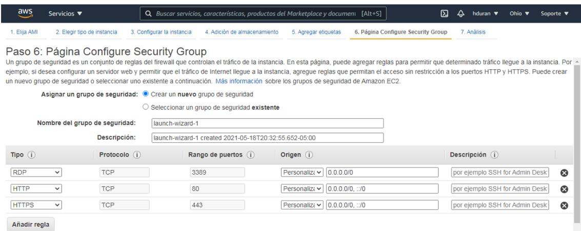
Figura 29. Pantalla de configuración de reglas de firewall.
