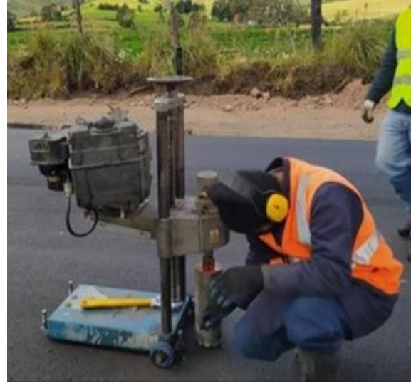
Figura 2. Extracción de núcleos mediante taladrado
