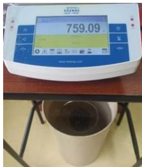
Figura 3. Muestra sumergida y toma de datos de masa sumergida para ensayo de Densidad Bulk
