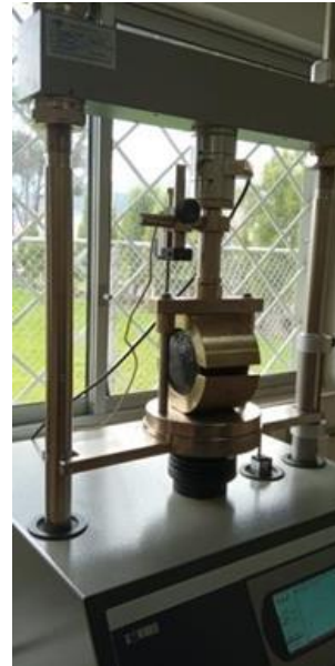
Figura 5. Prueba de Estabilidad y Flujo. Máquina Marshall
