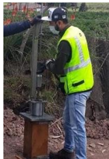
Figura 1. Compactación manual de briquetas en sitio
