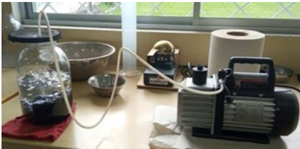
Figura 4. Ensayo RICE, método manual
