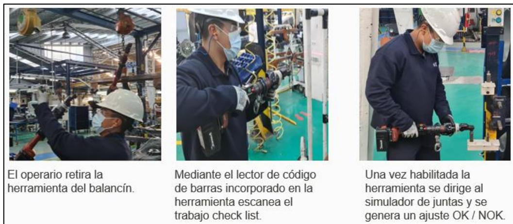
**Figura 44 :** Proceso anterior check list error proofing
