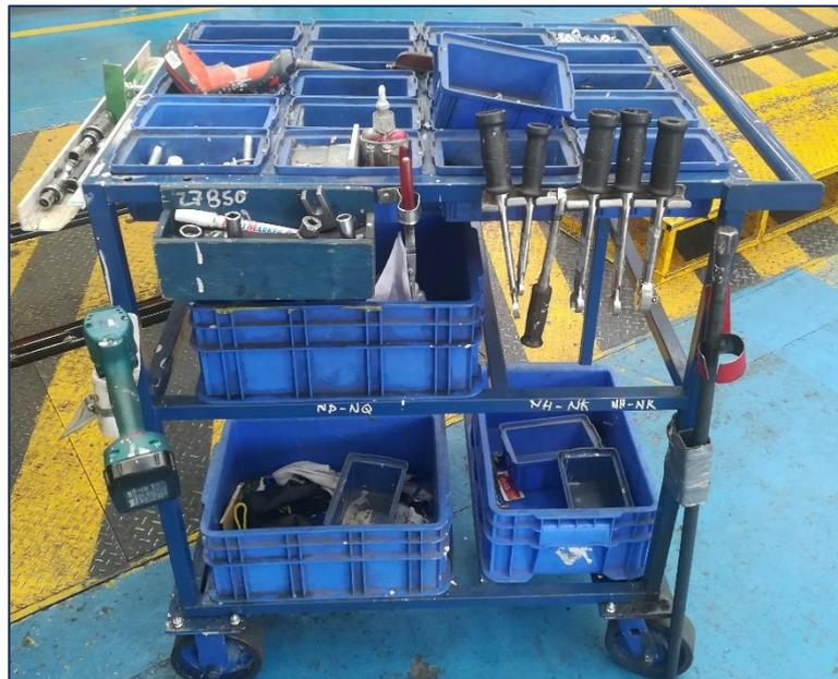
**Figura 41 :** Rack móvil para herramientas.
