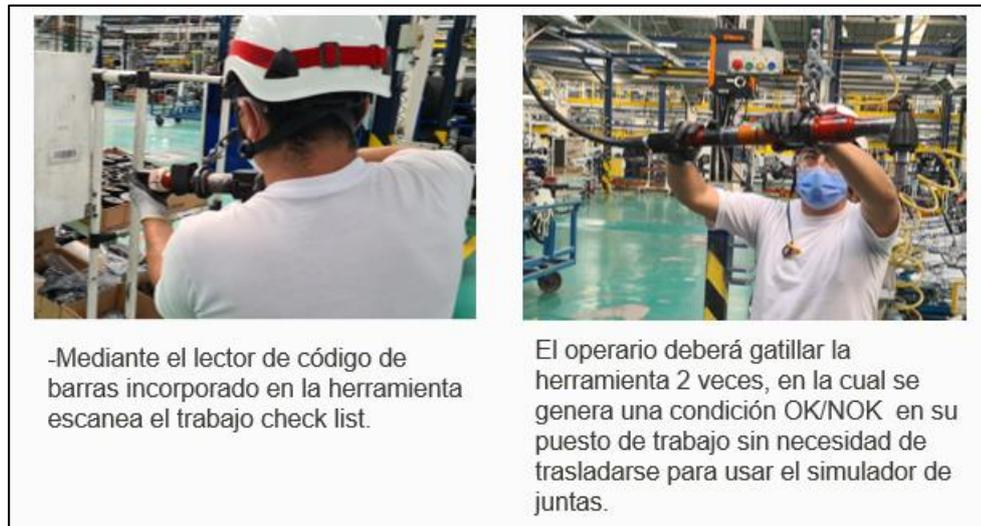
**Figura 45 :** Proceso actual check list error proofing
