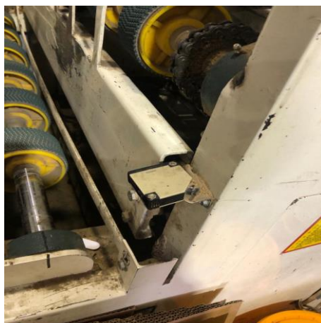
Figura 20. Sensor en secado por aire. (Fuente: Autor)
