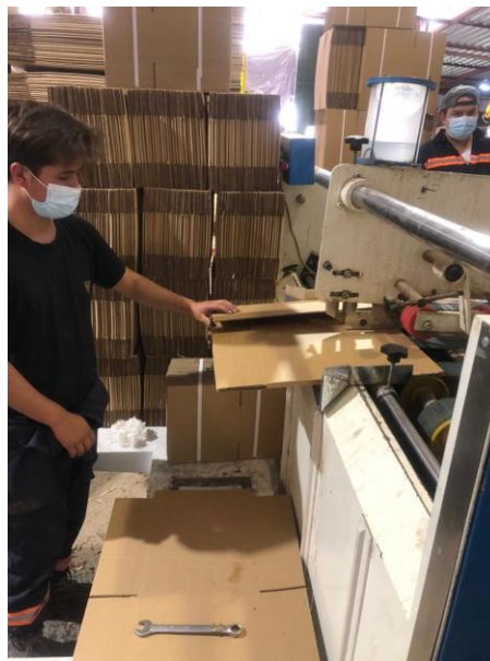
Figura 18. Doblado de cajas manualmente. (Fuente: Autor)
