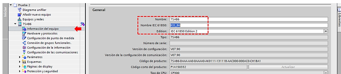
Figura 106. Ajuste de nombre IEC 61850 del IED para Prueba #2. Fuente: Autores.
