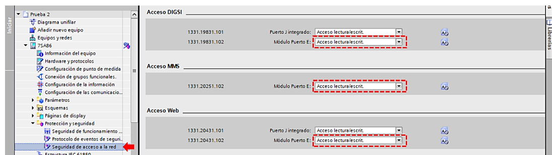
Figura 110. Ajuste de seguridad de acceso a la red para Prueba #2. Fuente: Autores.
