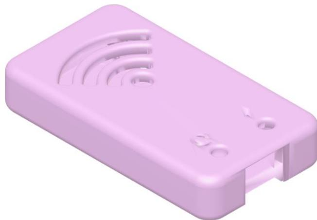
*Figura B. 1 Conjunto Carcasa ESP-8266*
