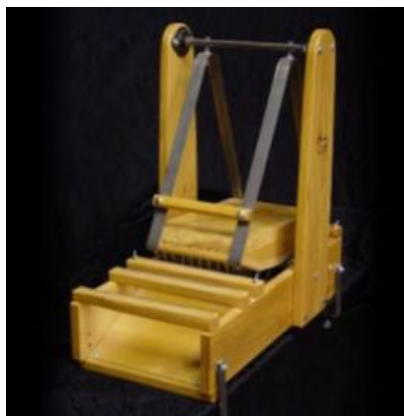
Fig. 5 Escarmenadora de madera tipo péndulo. (Chanjé, Peche, & Aucahuasi, 2017)
