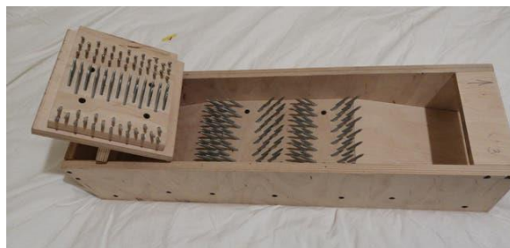
Fig. 6 Escarmenadora de madera tipo cajón. (Natalia N, s.f.)
