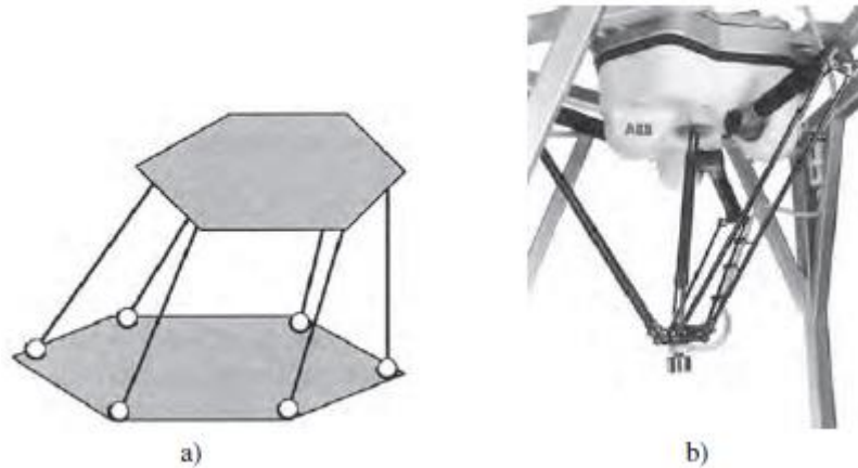
Fig. 4. Estructuras paralelas: a) Plataforma de Stewart-Gough. b) Robot industrial Paralelo
