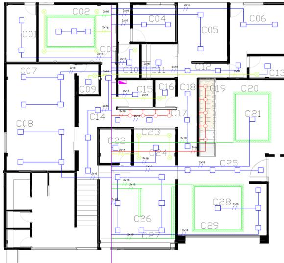
**Figura 41:** Circuitos de iluminación de la planta baja.
