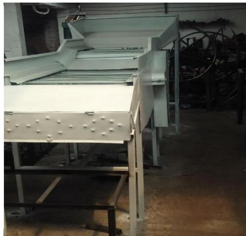
Figura 8. Maquina Clasificadora de Rodillos
