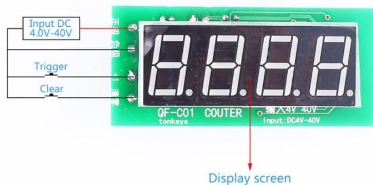
Figura 78. Módulo contador de pulsos
