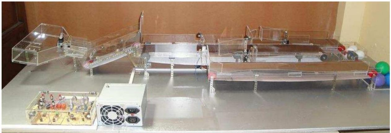
Figura 11. Maquina Clasificadora con Sensores Fotoeléctricos
