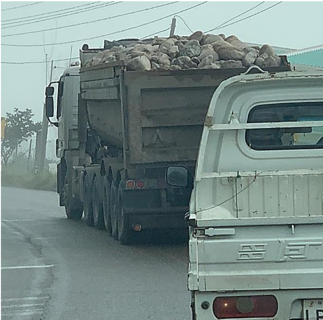
Figura 12. Vehículo con carga excesiva vía Girón.
