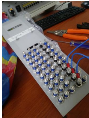
Figura 3.31. Inicialización de lámina, montaje y ajuste de elementos
