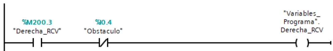
Figura 46. Señal del módulo maestro para que avance derecho.
