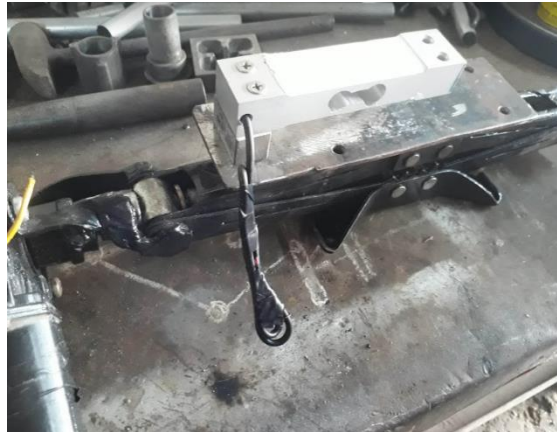
Figura 3.49. Colocación de celda de carga.
