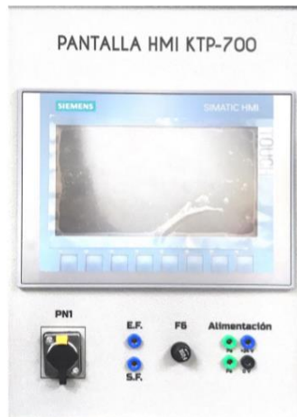
Figura 3.17. Lámina de pantalla HMI KTP-700 armada con sus elementos.
