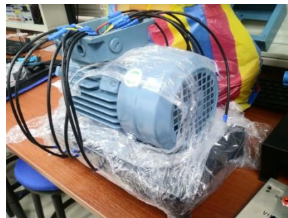
Figura 3.59. Colocación adicional de cables para bobina.
