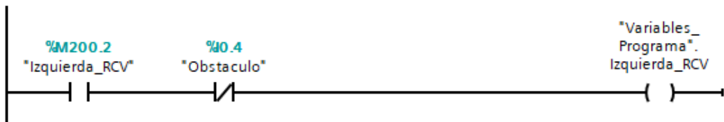
Figura 45. Señal del módulo maestro para que avance izquierdo.
