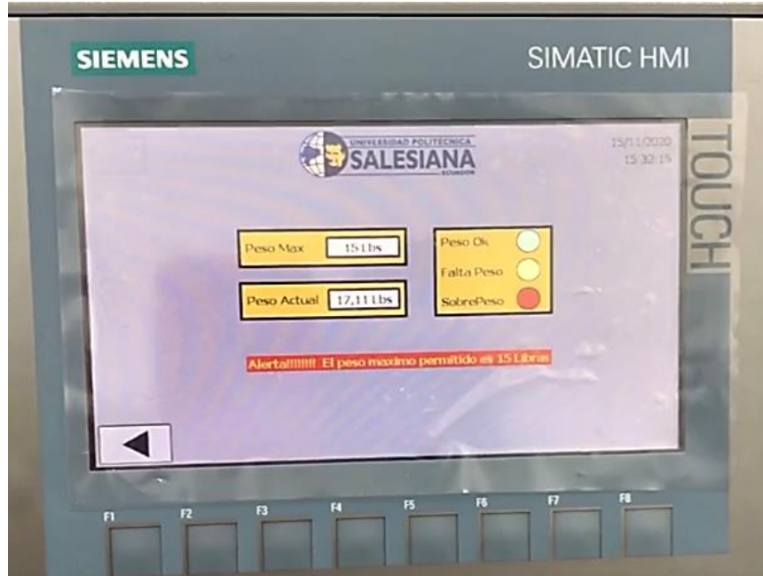
Figura 29. Activación de alarma por sobrepeso.
