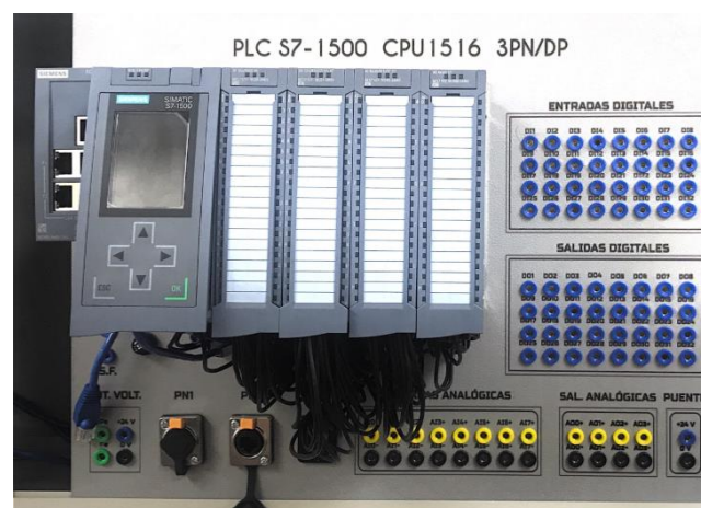
Figura 3.20. Lámina PLC S7-1500 armada con sus elementos.
