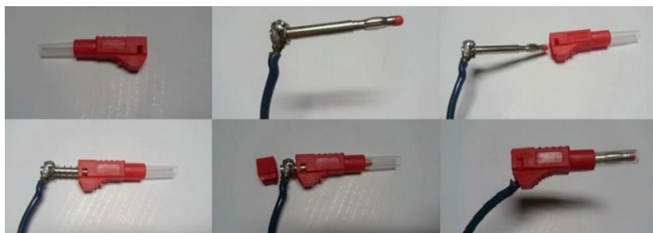
Figura 3.69. Proceso para elaboración de plugs banana. (Guerron & Uquillas, 2020)
