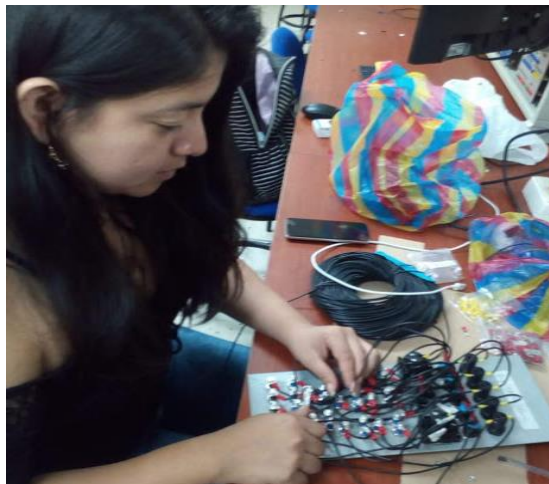
Figura 3.66. Montaje y conexión interna de elementos de lámina del módulo estudiantil.
