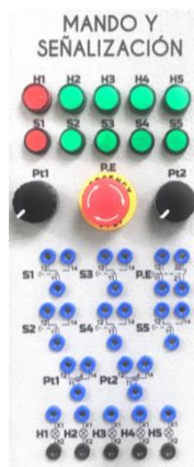
Figura 3.25. Lamina de señal y mando culminada.
