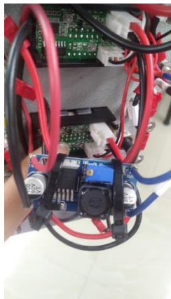
Figura 3.24. Colocación de módulo conversor de voltaje DC-DC.
