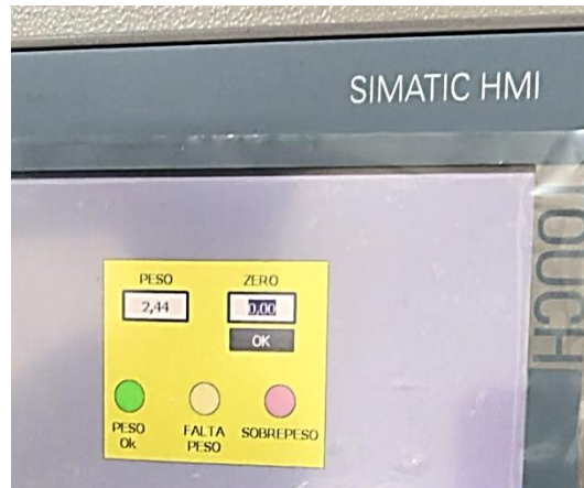
Figura 30. Valor inicial dado por el peso de la tapa del robot.
