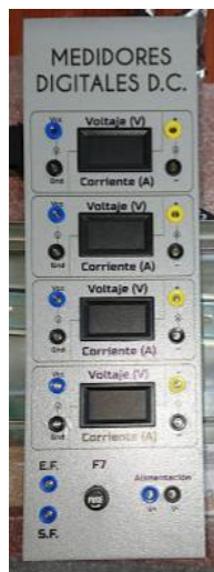
Figura 3.22. Lámina de medidores DC terminada y probada.
