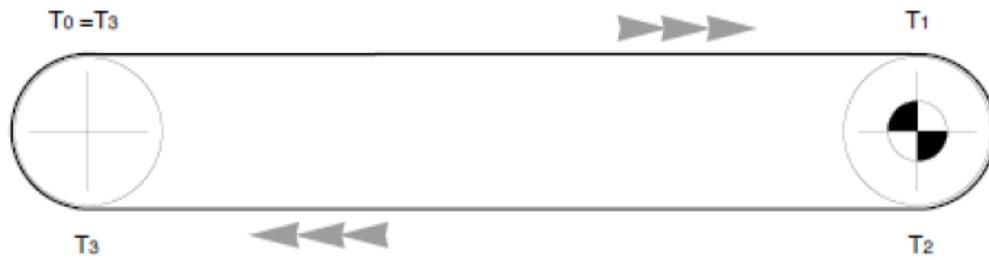
**Figura 19:** Tensiones de la banda.
