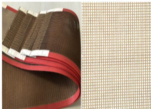
**Figura 42:** Banda transportadora recubierta de teflón.
