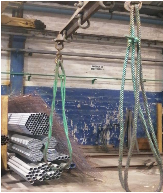
Foto 01: Cabos en mal estado.
