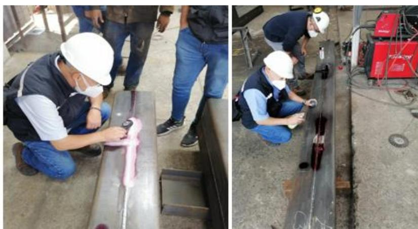
Figura 54 Pruebas de tintas penetrantes a las columnas C1 por parte de fiscalización
