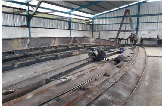
*Figura 7 Realización de pórticos metálicos, falta de espacio para fabricación. Fuente: Autor*
