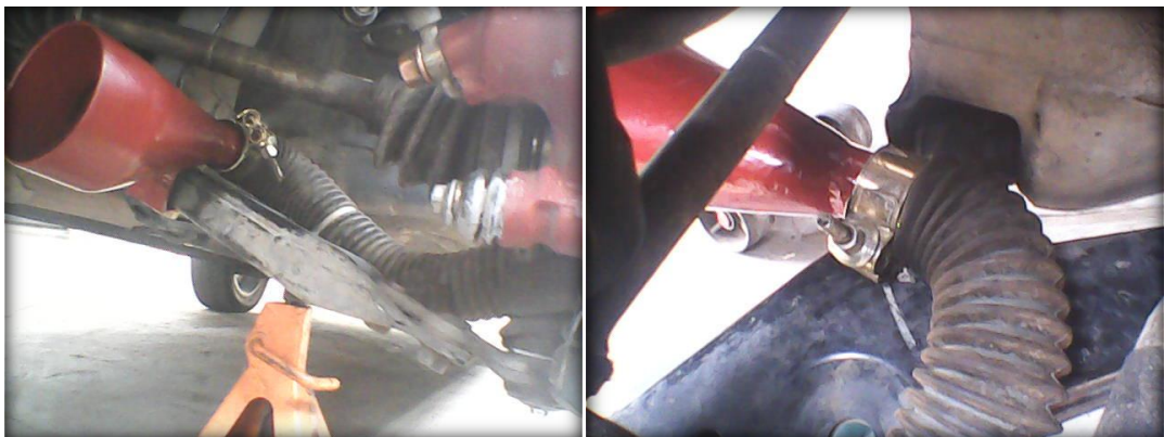
Fig. 4.33. Ensamble de los restrictores de aire. Fuente: Los Autores.
