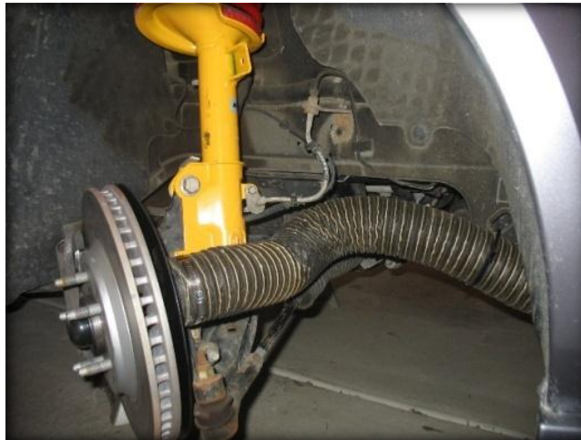
Fig. 2.18. Disposición del tubo de refrigeración. Fuente: http://clubgta.creatuforo.com
