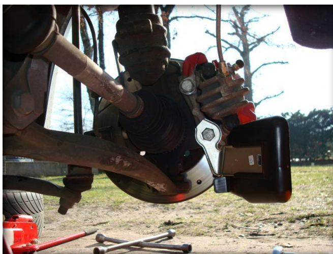
Fig. 3.4. Instalación de la aleta de dirección de aire. Fuente: http://clubc2.es
