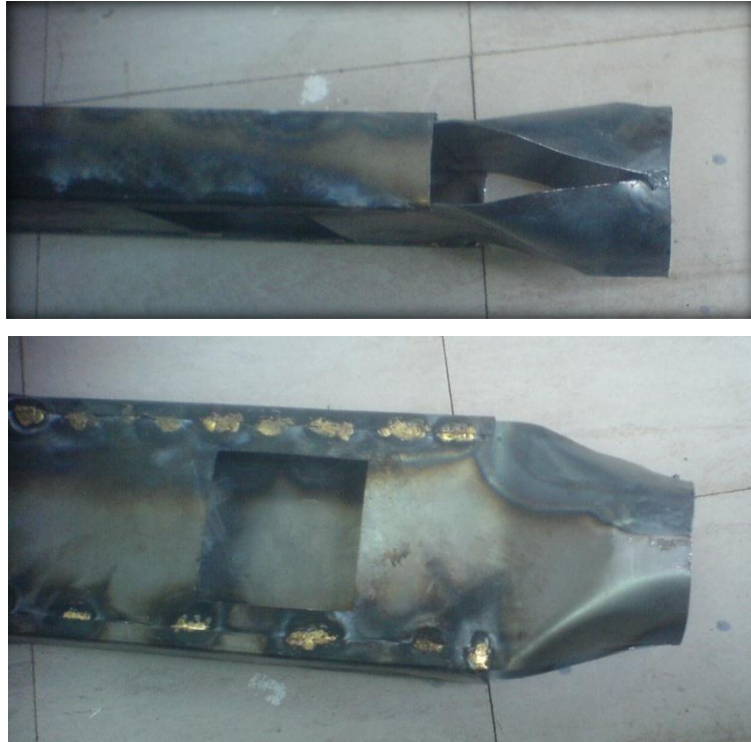
Fig. 4.5. Modificación de la sección rectangular a circular de la tubería. Fuente: Los Autores.
