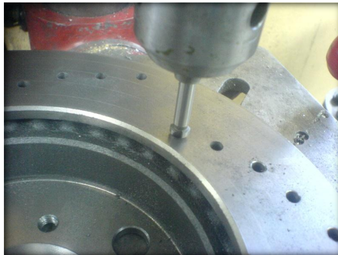
Fig. 4.15. Avellanado de los agujeros de perforación del disco de freno. Fuente: Los Autores.
