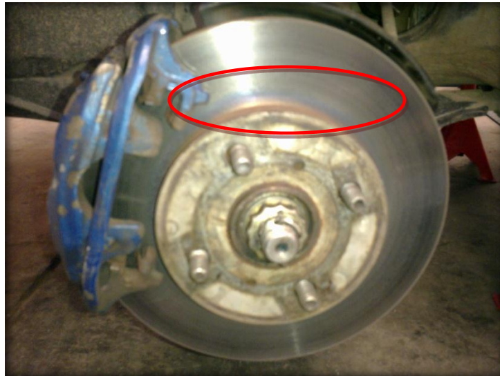
Fig.1.28. Disco de freno defectuoso por temperaturas excesivas. Fuente: Los Autores.
