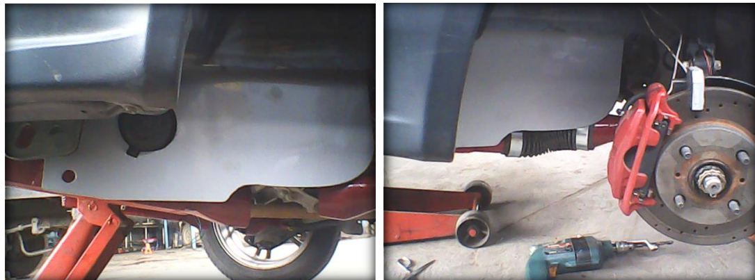
Fig. 4.35. Ubicación del protector y manguera flexible de 3 plg. Fuente: Los Autores.
