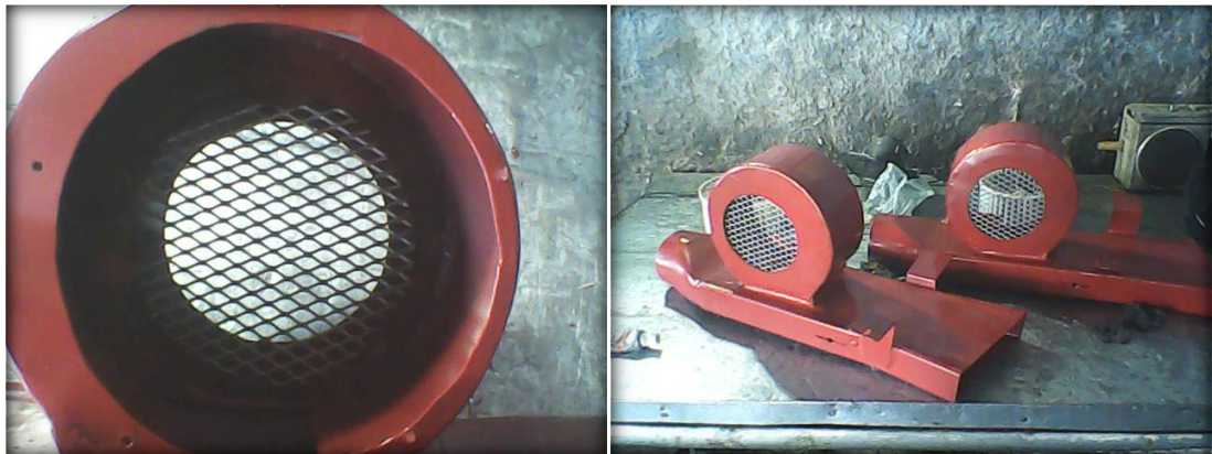
Fig. 4.28. Colocación de la malla de protección de ventiladores. Fuente: Los Autores.
