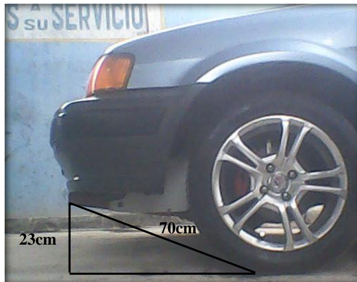
Fig. 3.23. Dimensiones modificadas del ángulo de ataque del vehículo. Fuente: Los Autores.
