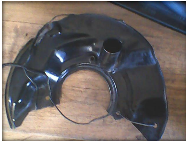
Fig. 4.12. Acople de la tubería de ventilación en el plato de protección del disco de freno. Fuente: Los Autores.
