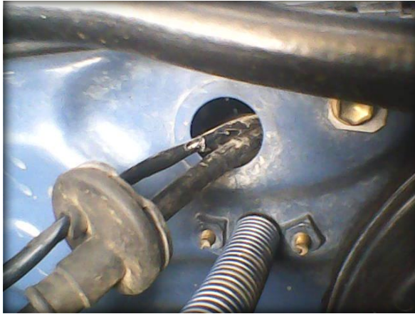
Fig. 4.48. Agujero de paso de cableado. Fuente: Los Autores.
