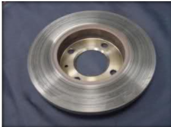
Fig. 1.27. Desgaste irregular del disco de freno. Fuente: http://i36.tinypic.com
