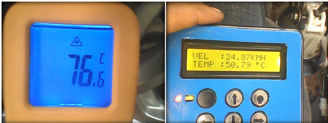
Fig. 4.71. Temperatura del disco, al final de la prueba de ruta. Fuente: Los Autores.
