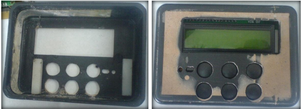
Fig. 4.25. Caja de circuito principal de PVC. Fuente: Los Autores.
