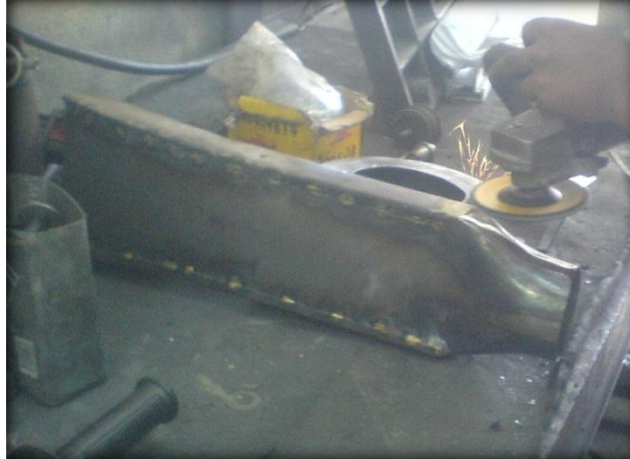
Fig. 4.7. Amolado de las superficies rugosas por suelta. Fuente: Los Autores.
