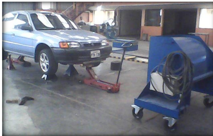
Fig. 4.52. Disposición del vehículo y ventilador. Fuente: Los Autores.
