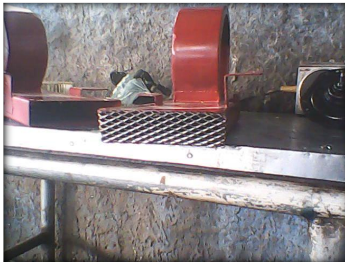
Fig. 4.29. Malla de protección de la tubería principal. Fuente: Los Autores.
