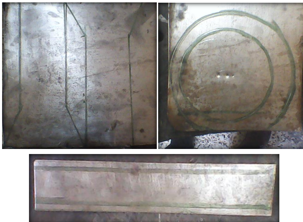
Fig. 4.1. Trazado de las partes de las tuberías de ventilación. Fuente: Los Autores.
