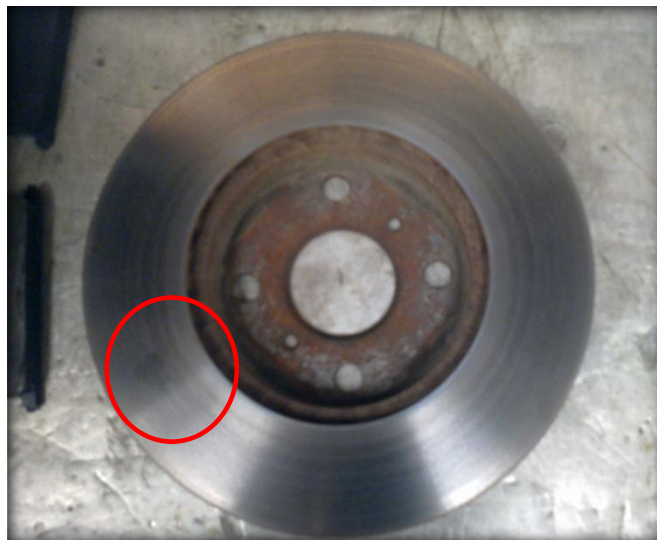
Fig. 1.26. Mancha de judder. Fuente: Los Autores.
