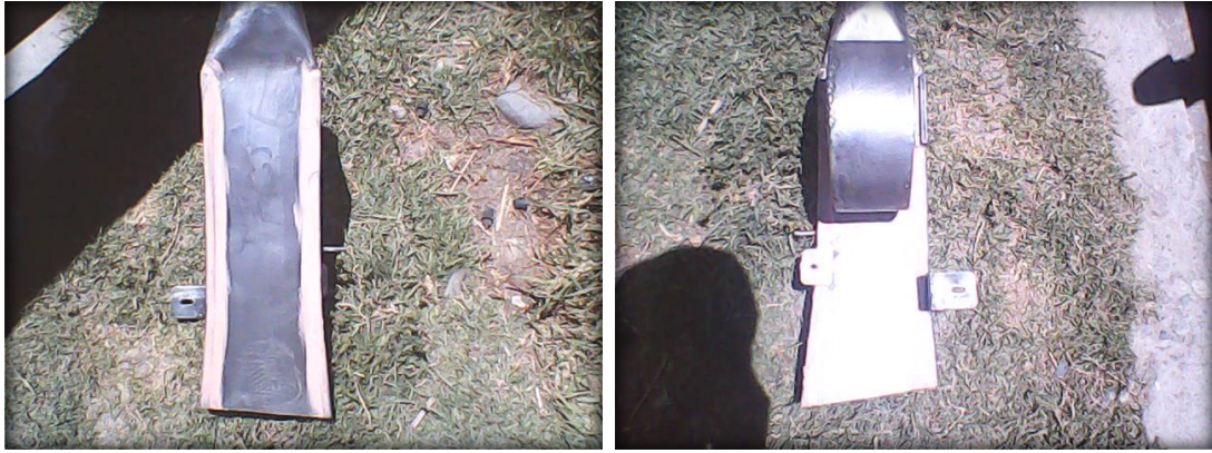
Fig. 4.9. Preparación de las tuberías antes del pintado. Fuente: Los Autores.
