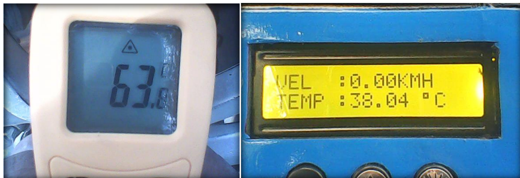
Fig. 4.67. Temperatura del disco, al final del primer recorrido de la prueba de ruta.
