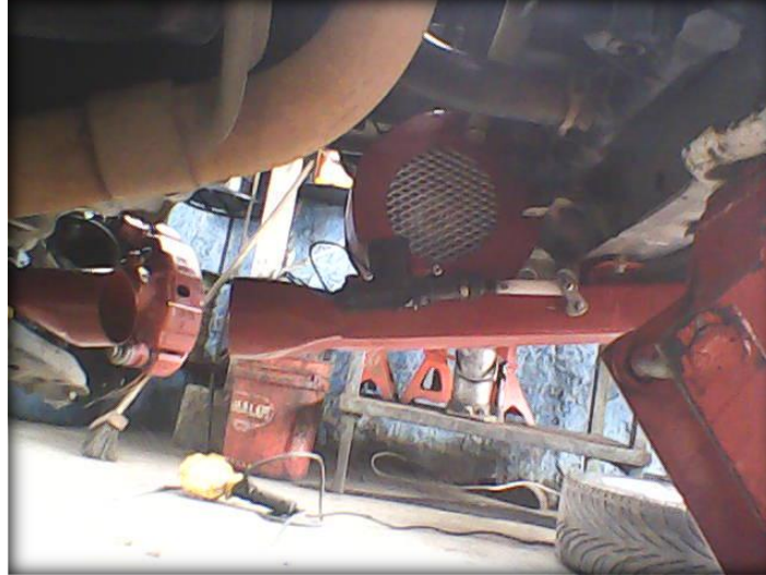
Fig. 4.34. Tubería de ventilación debajo de parachoques. Fuente: Los Autores.
