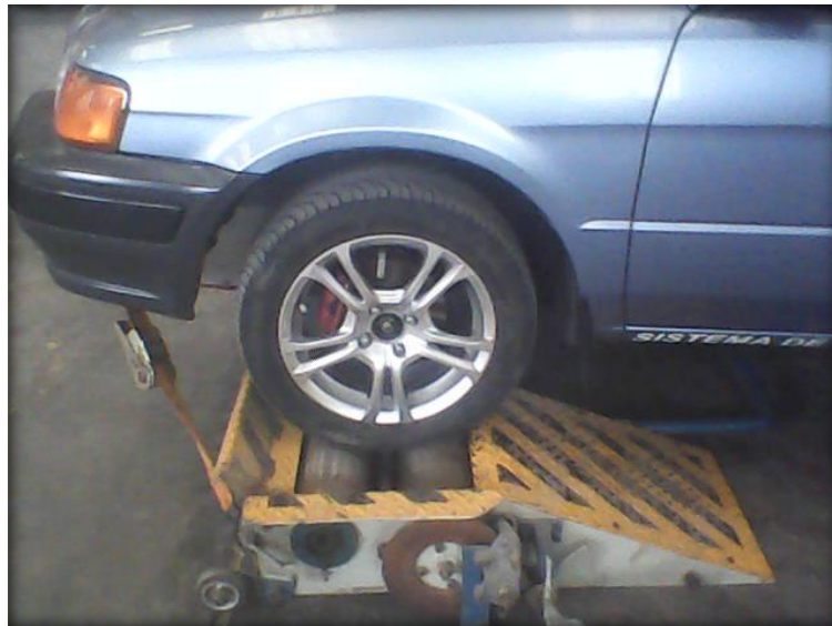
Fig. 4.59. Sujeción del vehículo al banco de rodillos. Fuente: Los Autores.
