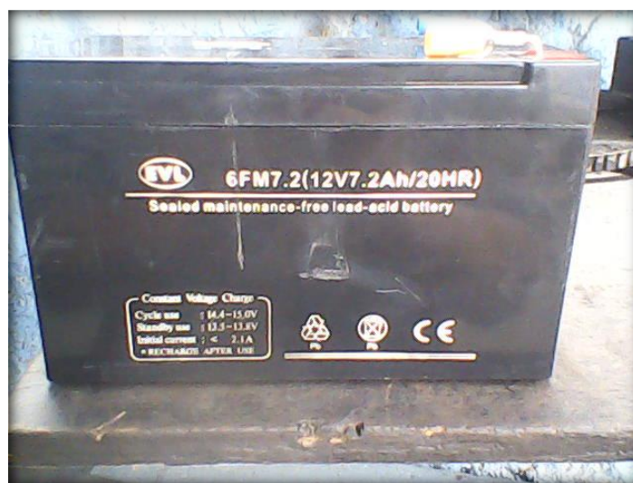
Fig. 4.37. Batería de alimentación del circuito electrónico. Fuente: Los Autores.
