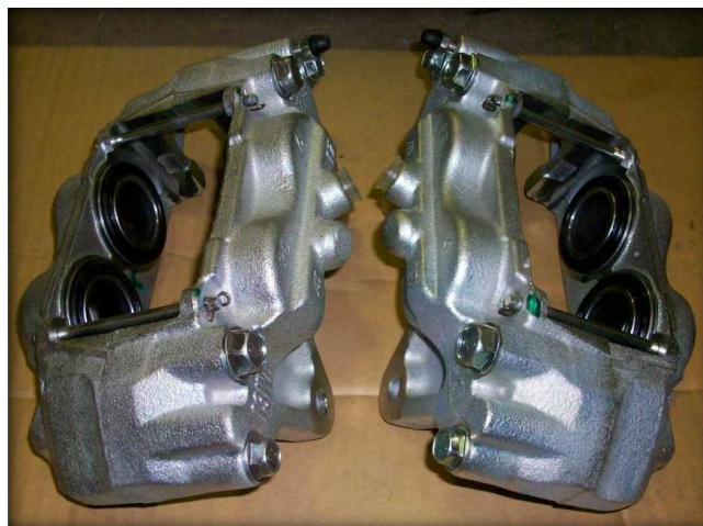
Fig. 1.13. Pinzas de cuatro pistones opuestos. Fuente: www.mercadoracing.org
