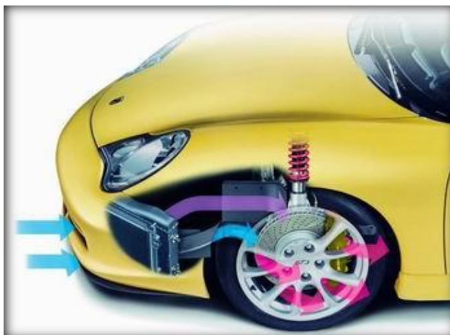
Fig. 3.3. Sistema de refrigeración de frenos de porsche. Fuente: www.powerzone.com.uy
