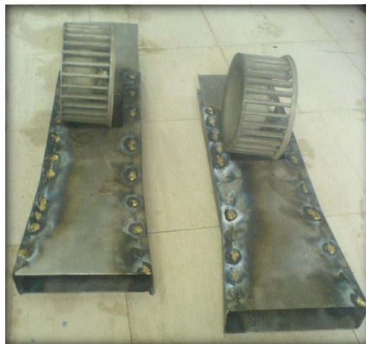
Fig. 4.4. Rodetes de los electros ventiladores en la posición de ensamble. Fuente: Los Autores.
