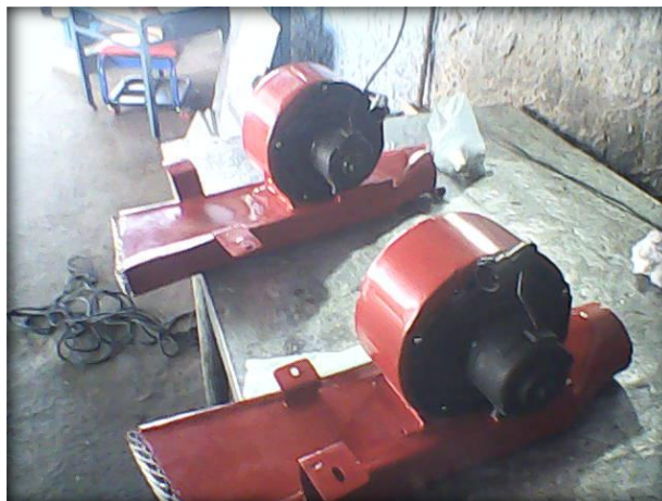
Fig. 4.31. Disposición de los electros ventiladores. Fuente: Los Autores.
