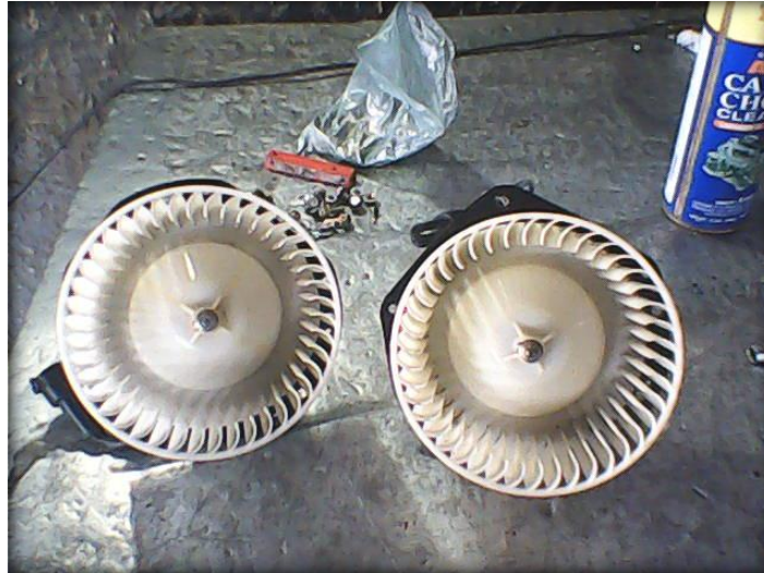
Fig. 4.30. Ensamble de los rodetes de ventilación. Fuente: Los Autores.
