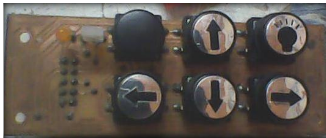
Fig. 4.23. Circuito de botones del control de temperatura. Fuente: Los Autores.
