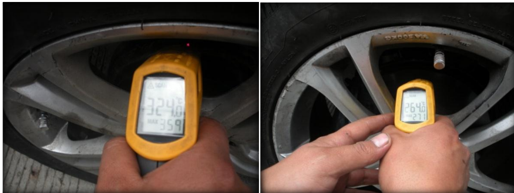
Fig. 1.50. Temperatura alcanzada por el tambor y disco de freno. Fuente: Los Autores.
