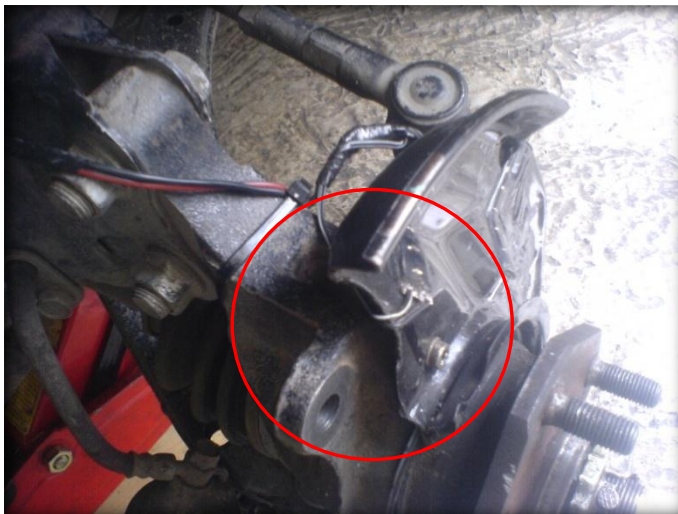
Fig. 4.20. Lugar de acople del sensor de rpm. Fuente: Los Autores.
