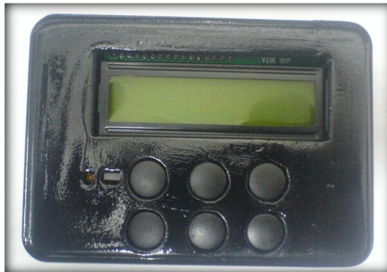
Fig. 4. 26. Monitor de velocidad y temperatura con la botonera de funciones. Fuente: Los Autores.
