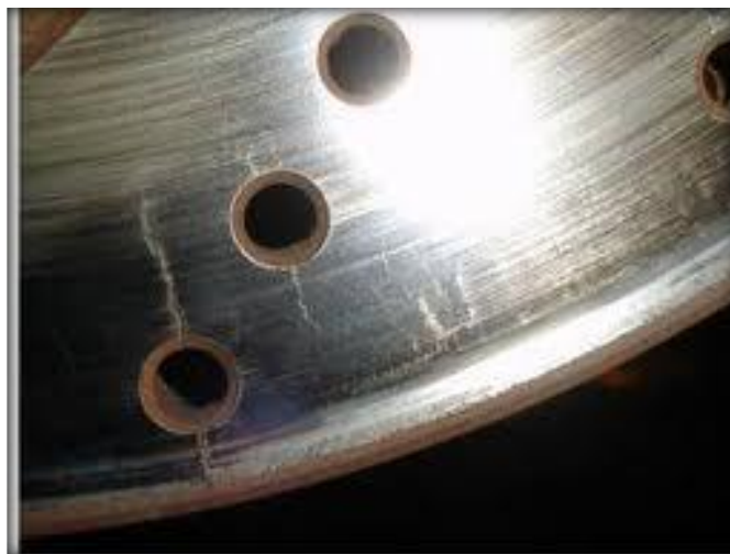
Fig. 2.7. Grietas en un disco perforado. Fuente: http://www.razine.com
