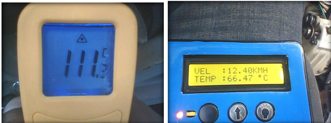
Fig. 4.70. Temperatura del disco, al final del primer recorrido de la prueba de ruta. Fuente: Los Autores.
