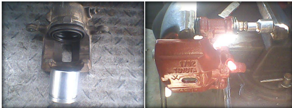
Fig. 4.57. Ablandamiento del pistón y bujes de la mordaza de freno. Fuente: Los Autores.
