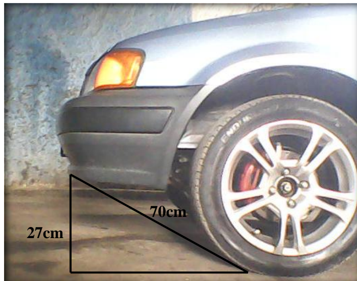
Fig. 3.22. Dimensiones estándar del ángulo de ataque del vehículo. Fuente: Los
