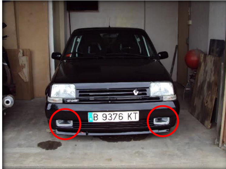
Fig. 2.16. Lugar de las entradas del flujo de aire. Fuente: http://www.forotandas.com
