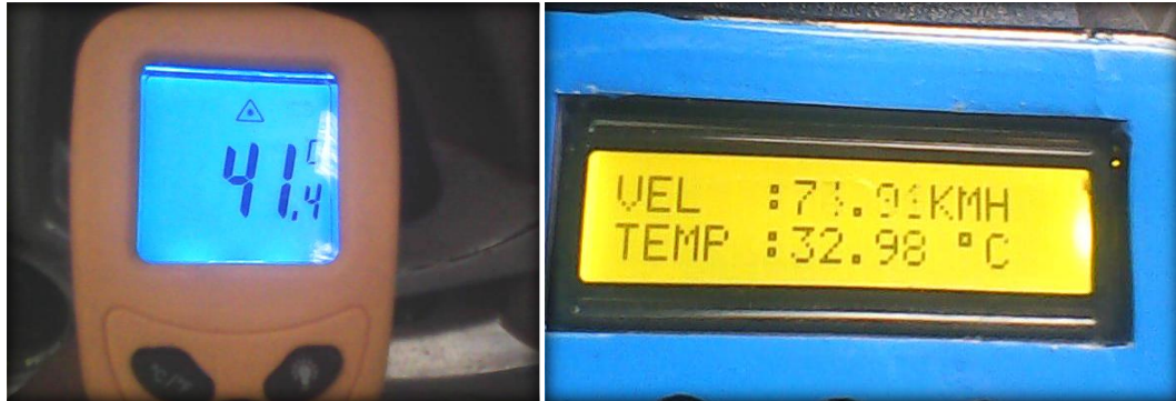
Fig. 4.68. Temperatura del disco, al final de la prueba de ruta. Fuente: Los Autores.
