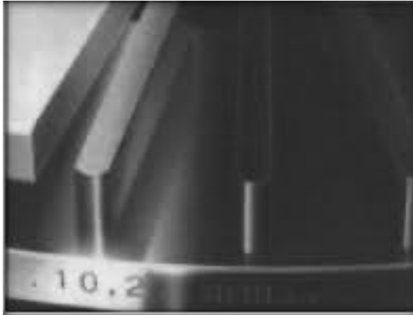
Fig. 1.9. Aleta de ventilación de un disco de freno. Fuente: http://i36.tinypic.com
