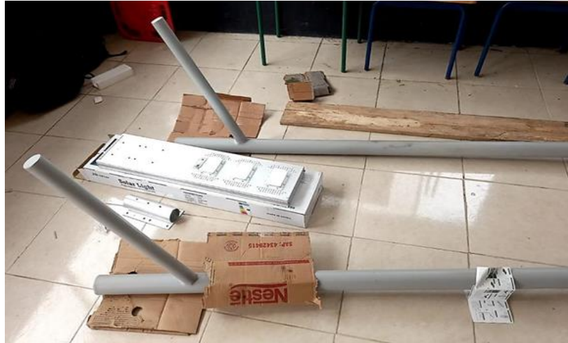
Figura 46. Postes y luminaria de 150W.
