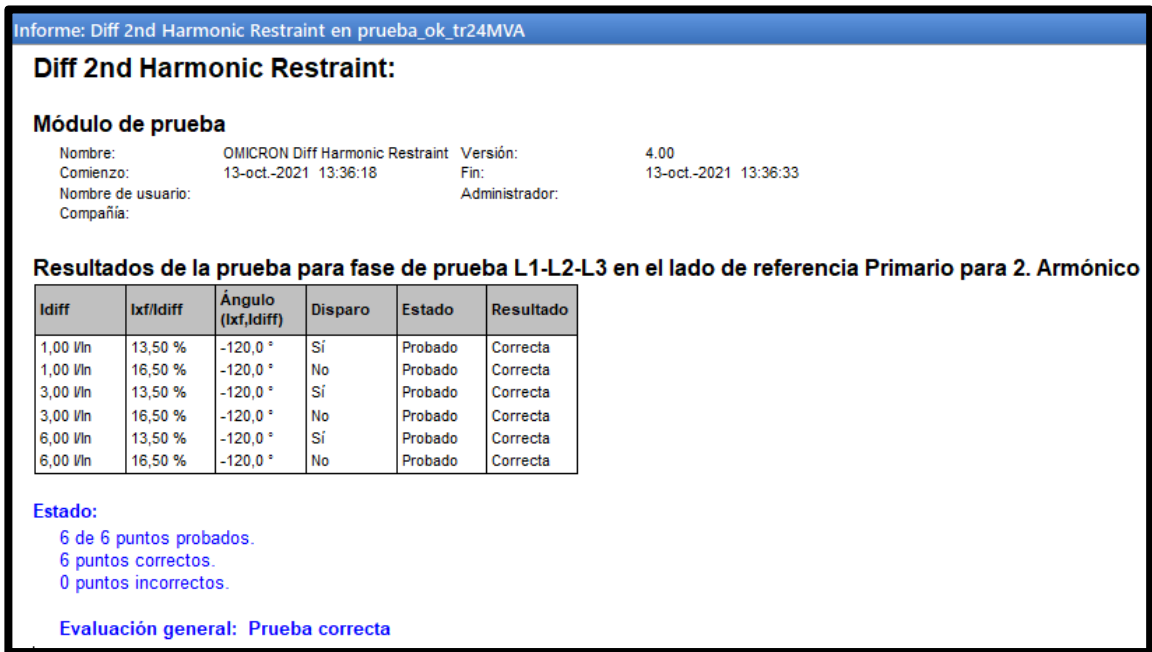
FIGURA 146 INFORME DE LA PRUEBA DIFF 2ND HARMONIC RESTRAINT. FUENTE: LOS AUTORES.
