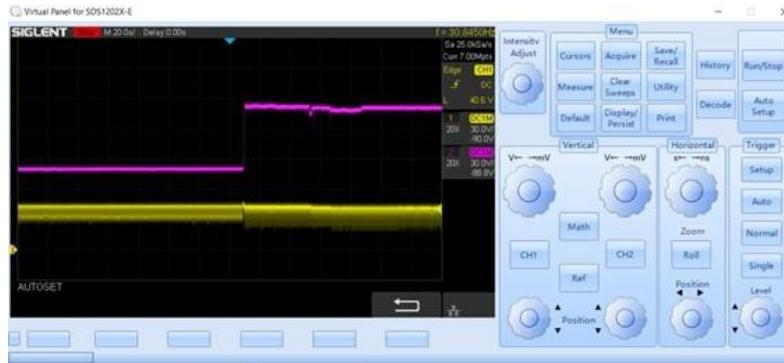
Figura 4.38: Respuestas del desempeño del sistema HIL relacionada con su salidas analogicas y visualizadas en el osciloscopio.
