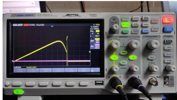
Figura 4.25: Respuesta de la simulación de la celda PV en un osciloscopio.
