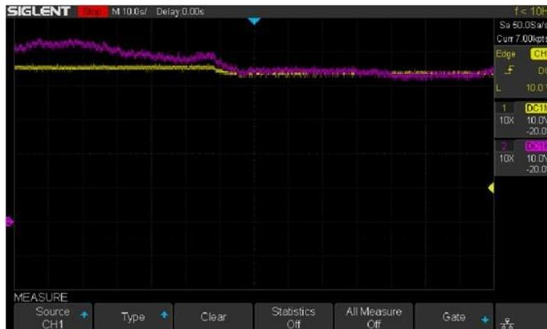
Figura 4.45: Señales de voltaje del boost y del PV del modelo emulado propuesto analizadas en el osciloscopio.
