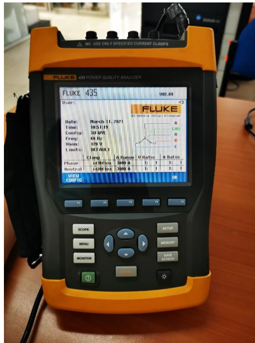
Anexo 19 Analizador de red utilizado en proyecto
