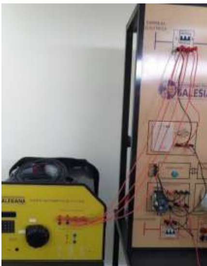
Figura 65: Conexión del Variac a Módulo ATS
