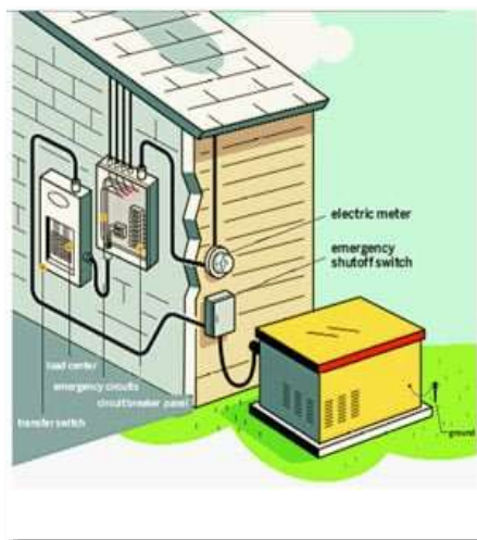
Figura 10: Generadores de reserva domésticos [33]
