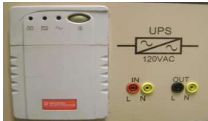
Figura 24: Sistema de alimentación ininterrumpido - Módulo de transferencia [17]
