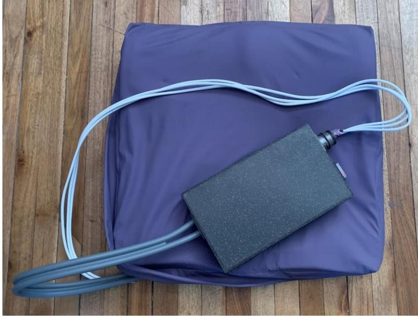
*Figura 30 Prototipo de asiento dinámico ensamblado*
