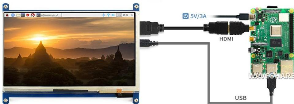
**Figura 5.** Conexión de la Pantalla + Raspberry pi 4
