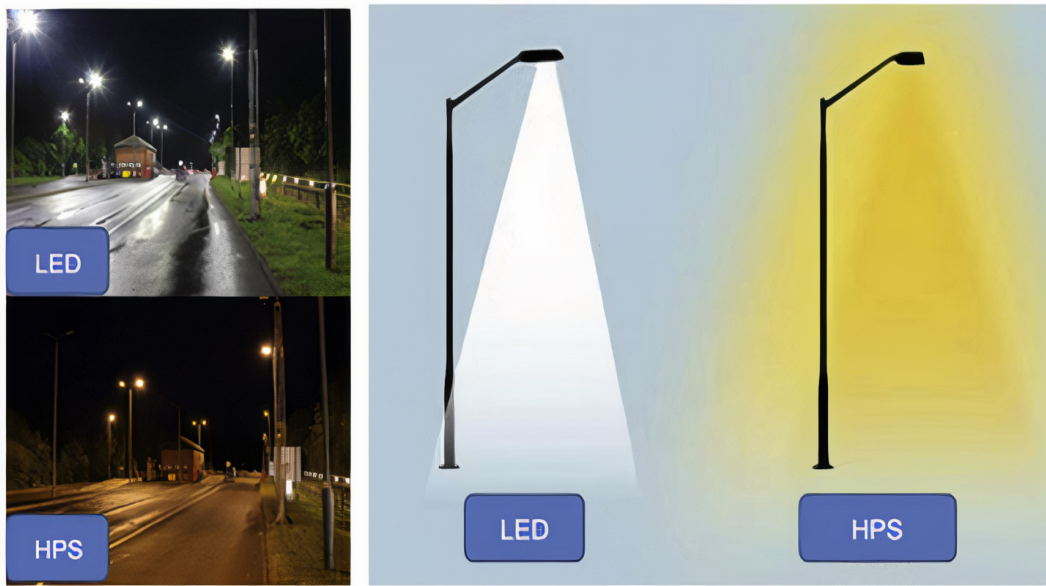
Figura 1.21: Comparación entre el alumbrado público LED (diodo emisor de luz) y HPS (sodio a alta presión) [25].
