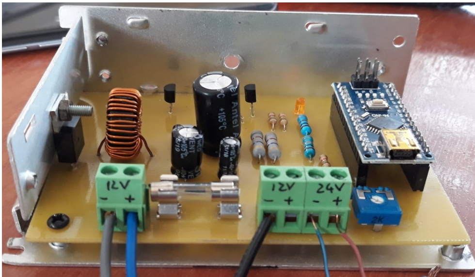
Figura 3.1: Circuito desarrollado del Convertidor Boost.
