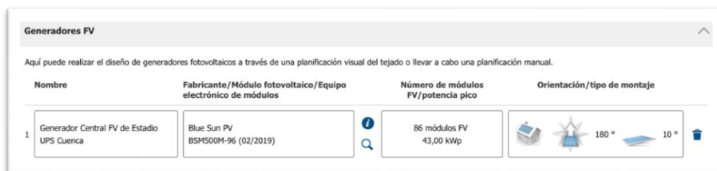
Figura 56. Configuración en Sunny Design Pro del tipo y cantidad de módulos fotovoltaicos a utilizar en propuesta 1.
