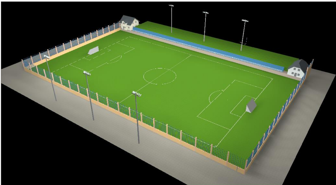
Figura 39. Iluminación del estadio Valeriano Gavinelli Bovio con luminarias LED propuesta 2 competencia. Fuente: Autores, Sistema de iluminación con luminaria LED en DiaLux, 10 de septiembre de 2020.
