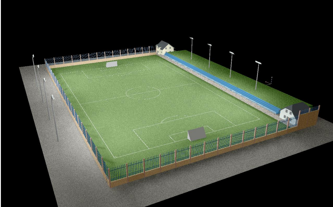
Figura 27. Iluminación del estadio Valeriano Gavinelli Bovio con luminarias LED Propuesta 1 competencia. Fuente: Autores, Sistema de iluminación con luminaria LED en DiaLux, 10 de septiembre de 2020.
