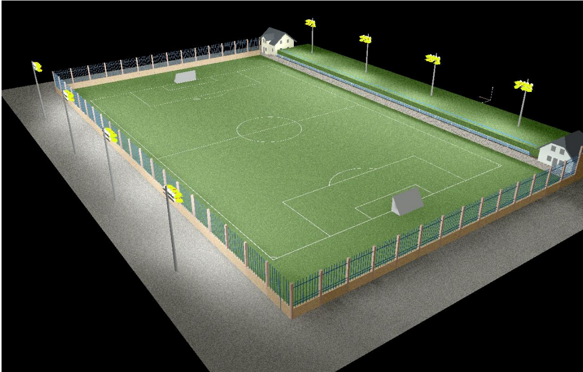
Figura 53. Iluminación del estadio Valeriano Gavinnelli Bovio con luminarias Halogenuros Metálicos. Fuente: Autores, Sistema de iluminación con luminaria Halogenuros Metálicos en Dialux, 21 de junio de 2021.
