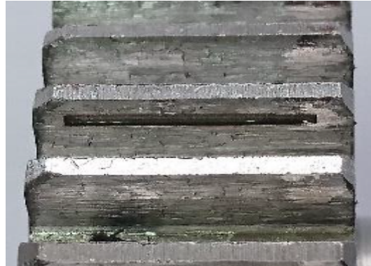
Figura 4.6: Dientes de engranaje con rayadura donde existe una línea de Profundidad 0,5 mm, Ancho 1 mm y Longitud 16 mm. (Fuente: documentos internos del grupo GIDTEC-UPS)
