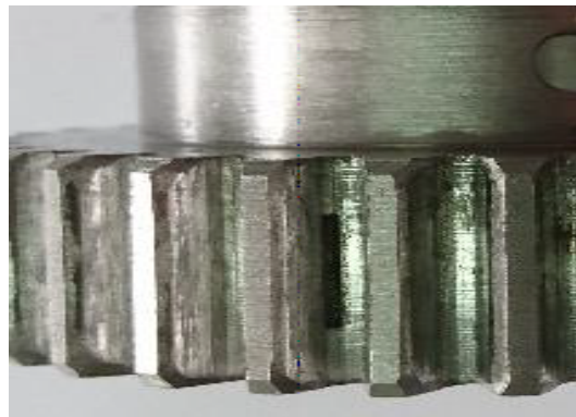
Figura 4.3: Grieta en el flanco del diente (Fuente: documentos internos del grupo GIDTEC-UPS)
