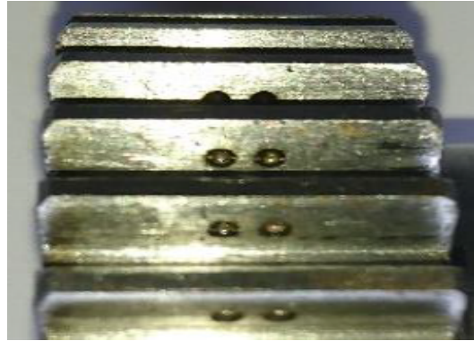
Figura 4.5: Dientes de engranaje con 2 agujeros por picadura, de Diámetro: 1,5 mm y Profundidad: 1,5 mm (Fuente: documentos internos del grupo GIDTEC-UPS)
