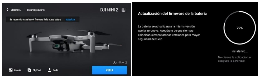
Ilustración 13 Requerimiento y actualización de Firmware de batería en el DJI MINI 2
