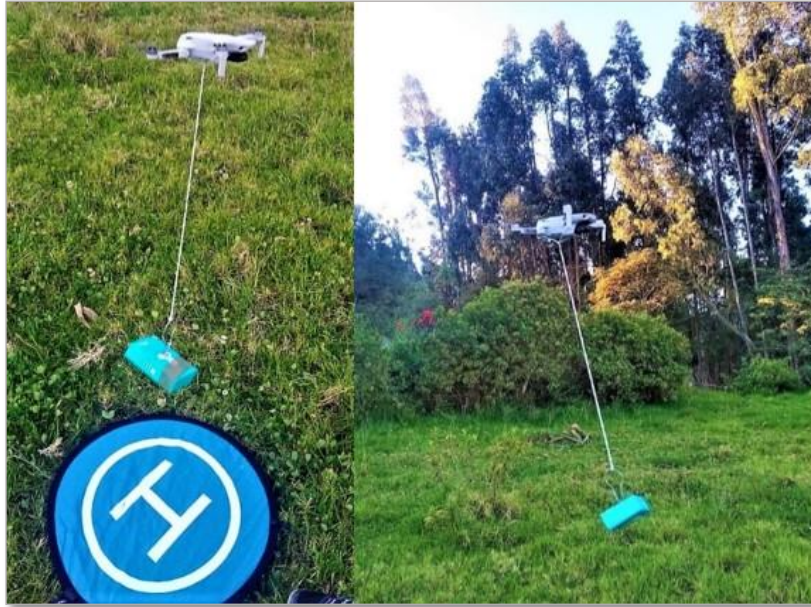
Ilustración 11 Prueba de carga útil de 112g en DJI MINI 2
