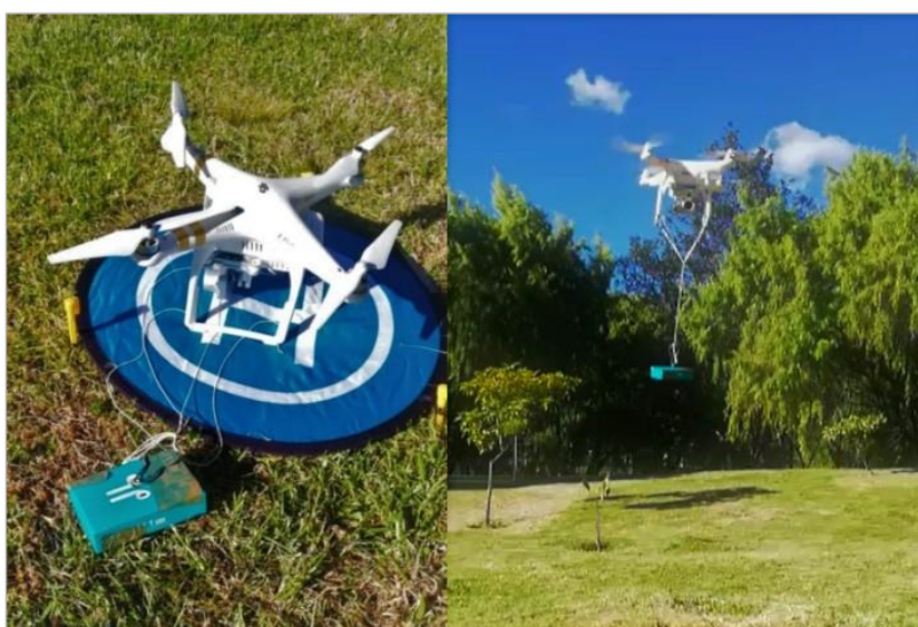
Ilustración 10 Prueba de carga útil de 112g en DJI PHANTOM 3 PROFESSIONAL
