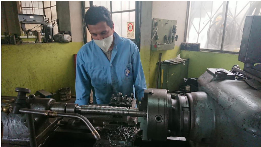
La imagen muestra el proceso de mecanizado del tornillo extrusor
