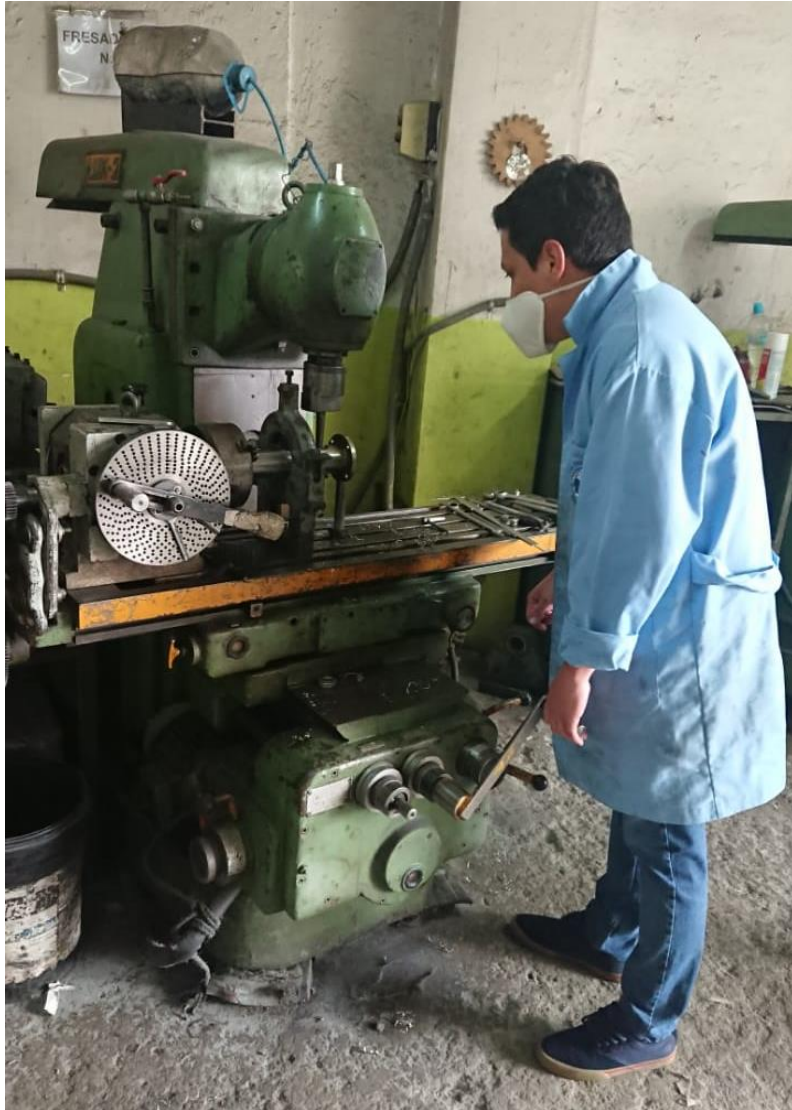
La imagen muestra el proceso de perforado de la camisa en donde irá soldada la boquilla de alimentación de dicha pieza.
