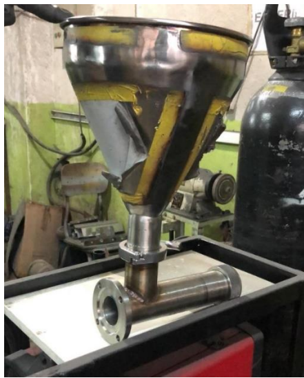
Figura 67. Ensamble de la camisa y tolva de alimentación. Fuente: autor
