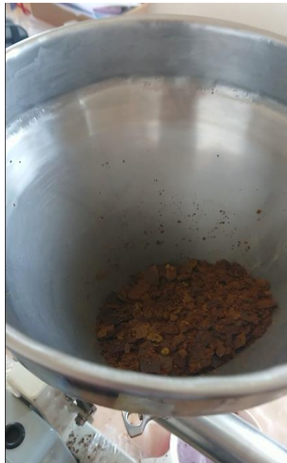
Figura 71. Llenado de materia prima en la tolva. Fuente: Autor
