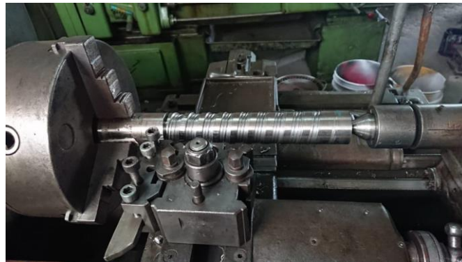
Figura 59. Mecanizado del tornillo extrusor cónico. Fuente: Autor
