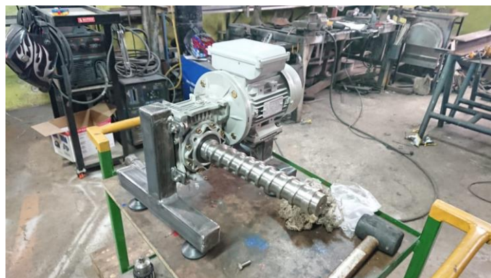
Figura 68. Acople del tornillo extrusor al motorreductor. Fuente: Autor
