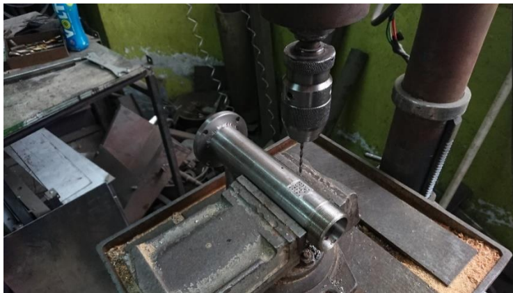
Figura 63. Proceso de perforación en la camisa. Fuente: Autor
