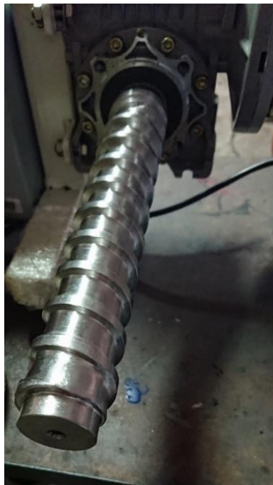
Figura 77. Tornillo extrusor corregido. Fuente: Autor
