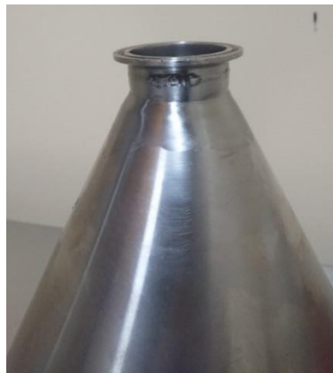
Figura 80. Reducción de la altura de la garganta de la tolva. Fuente: Autor
