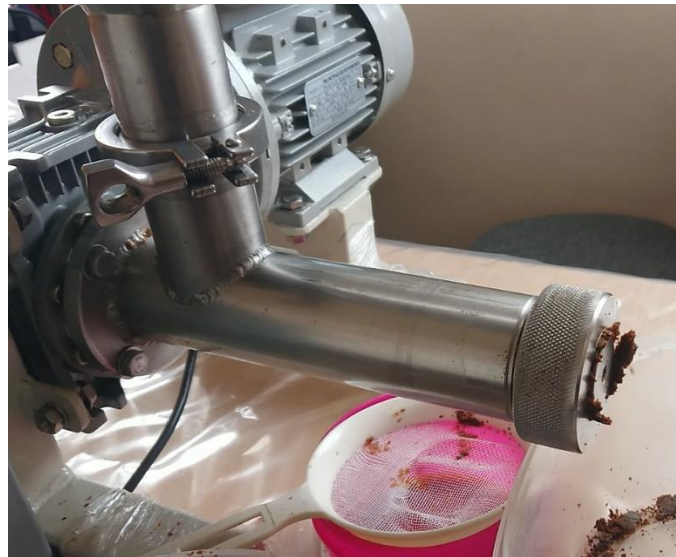
Figura 73. Salida de materia prima comprimida. Fuente: Autor
