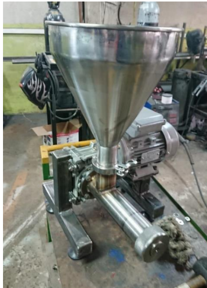
Figura 69. Colocación de la camisa al motorreductor. Fuente: Autor
