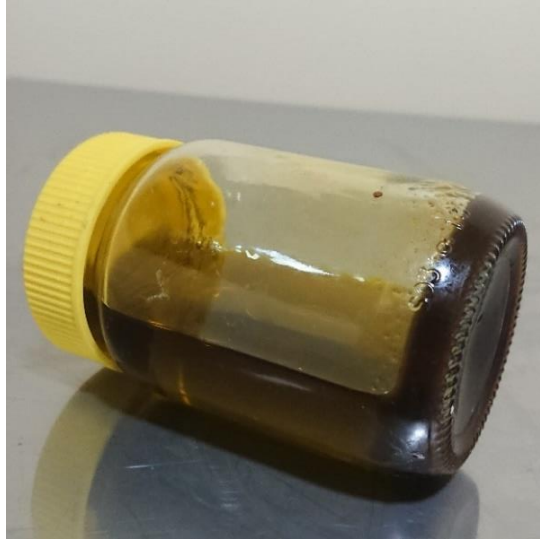
Figura 76. Impurezas en el aceite. Fuente: Autor
