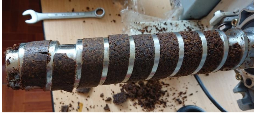
Figura 72. Materia prima atascada en el tornillo. Fuente: Autor
