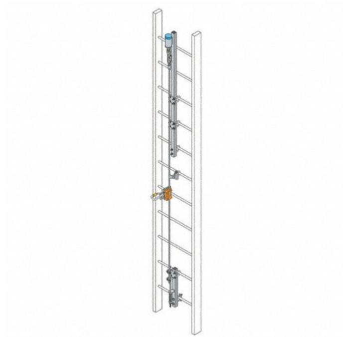
Figura 25. Línea de vida vertical fija con freno anticaída
