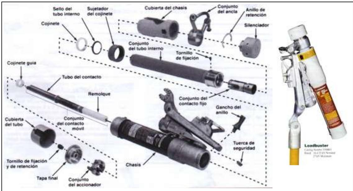
Fig7. Rompe carga y sus accesorios
