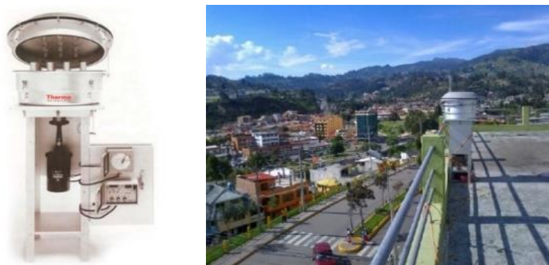
Figura 26. Muestreador activo Thermo-VCF-PM10
