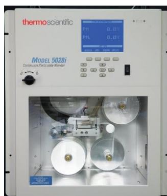
Figura 20. Analizador automático Thermo Scientific 5028i para material particulado PM 10 y PM 2,5
