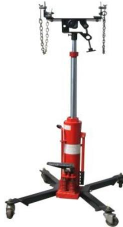
*Nota:* La figura muestra un gato hidráulico adecuado para movilizar transmisiones.
