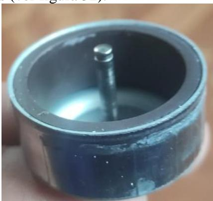
Figura 52: Imán del circuito de 24V obtenido del ventilador NIDEC UltraFlo. Fuente: Autores
