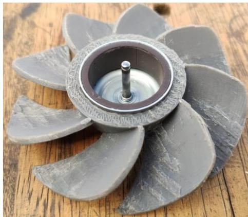
*Figura 56: Imán de 24V acoplado a las aspas, segundo prototipo. Fuente: Autores*
