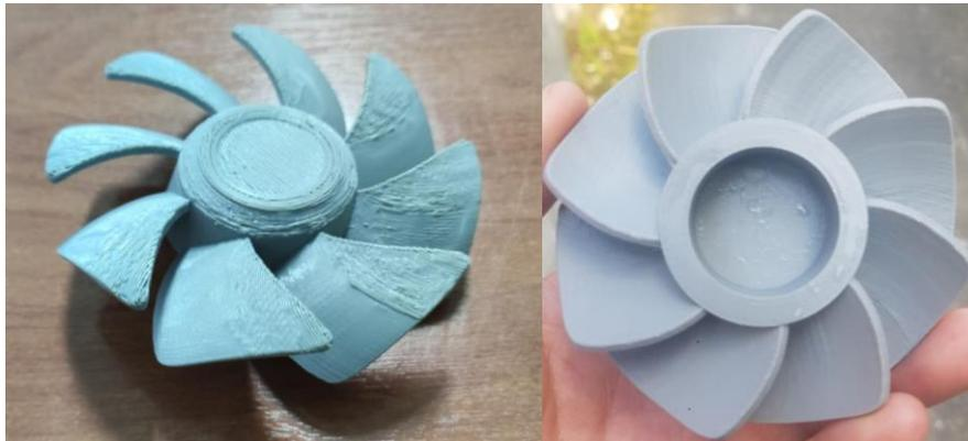
*Figura 48: Primer prototipo impreso de las aspas. Fuente: Autores*
