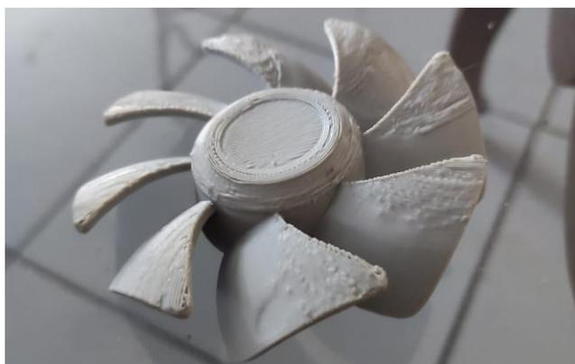
*Figura 53: Deformación de las aspas del primer prototipo. Fuente: Autores*
