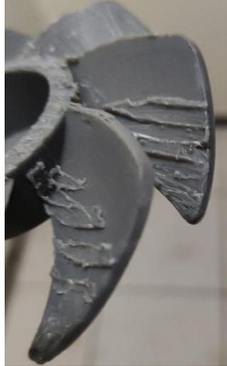
*Figura 55: Defectos superficiales de las aspas, segundo prototipo. Fuente: Autores*
