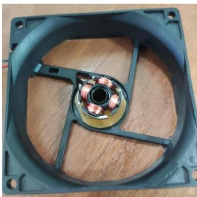
Figura 51: Circuito ventilador 24V obtenido del ventilador NIDEC UltraFlo. Fuente: Autores
