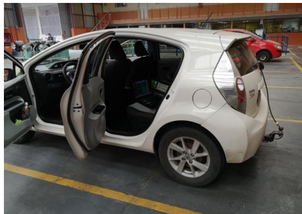
Figura 35. Instalar la sonda en el tubo de escape Fuente: Autores.
