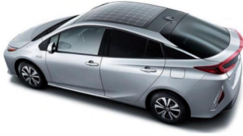
Figura 8. Aspecto de un panel solar de células fotoeléctricas en un Prius
