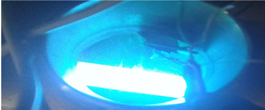
Fig.C 3 Prueba de encendido de la lámpara UV dentro del reactor [Fuente: Autor].
