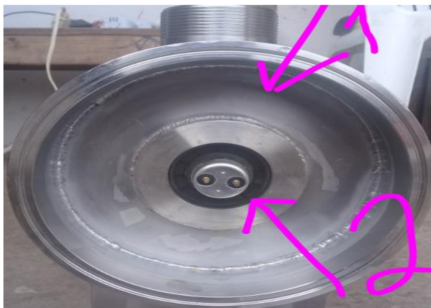
Fig.3 8 Vista supero y posterior de Reactor UV-C [Fuente: Autor].
