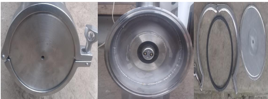
Fig.3 14 Protección del reactor de los terminales de lampara colocadas [Fuente: Autor].
