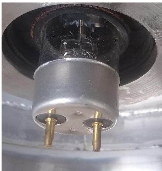
Fig.3 11 Colocación de lámpara UVC dentro del reactor. [Fuente: Autor].
