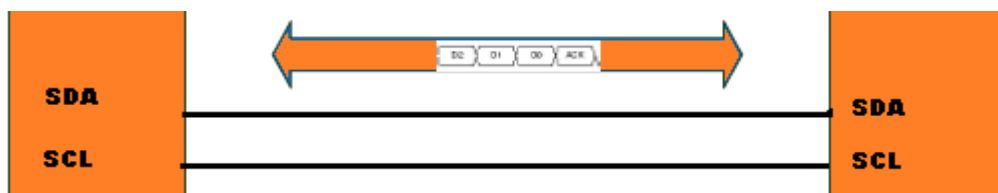
Fig.3 31 Comunicación I2C [Fuente: Autor].
