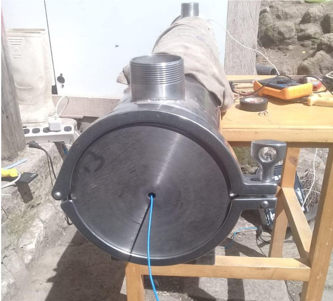
Fig.A 4 Final de la Construcción del reactor UV [Fuente: Autor].
