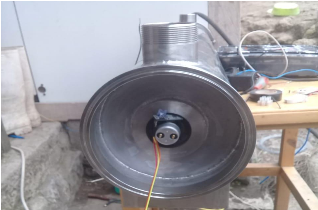
Fig.A 3 Colocación de la lámpara UV dentro del Reactor [Fuente: Autor].
