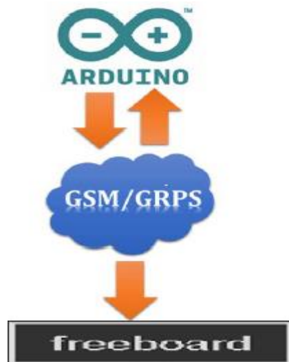
Fig.4 7 Envío de datos de los sensores a freeboard.io [Fuente: Autor].
